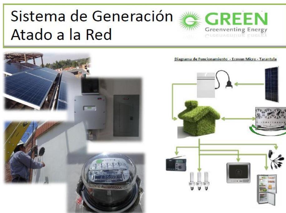
FIGURA 32: Sistema de generación atado a la red proporcionado por la empresa GREEN
