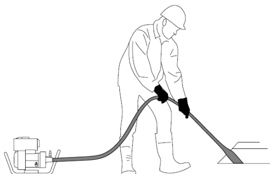
Figura 14. Modo de empleo de un vibrador modular interno
