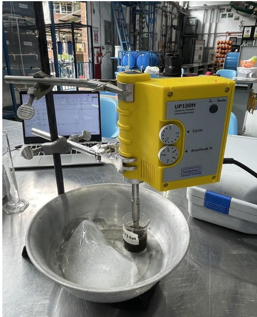
Ilustración 1. Sistema de extracción con procesador ultrasónico
