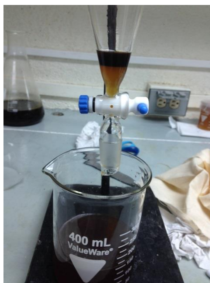
Figura 88. Decantación de la fase para obtener glicerina ya tratada.
