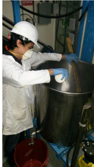
Figura 82. Adición de óxido de calcio a agua acidificada
