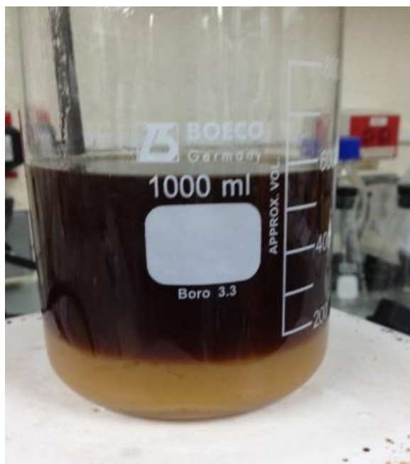
Figura 88. Decantación de la fase para obtener glicerina ya tratada.
