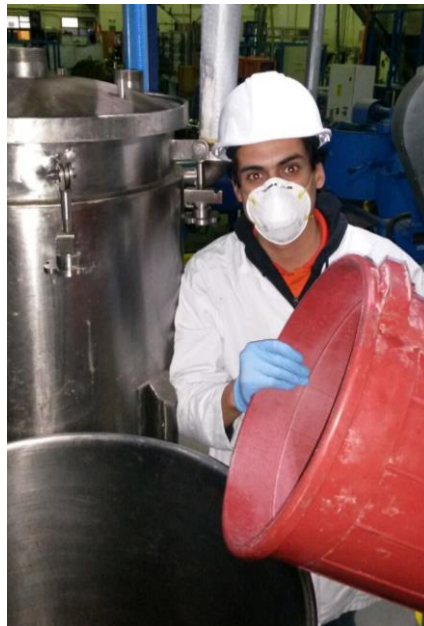
Figura 80. Adición de agua emulsionada a tanque de tratamiento
