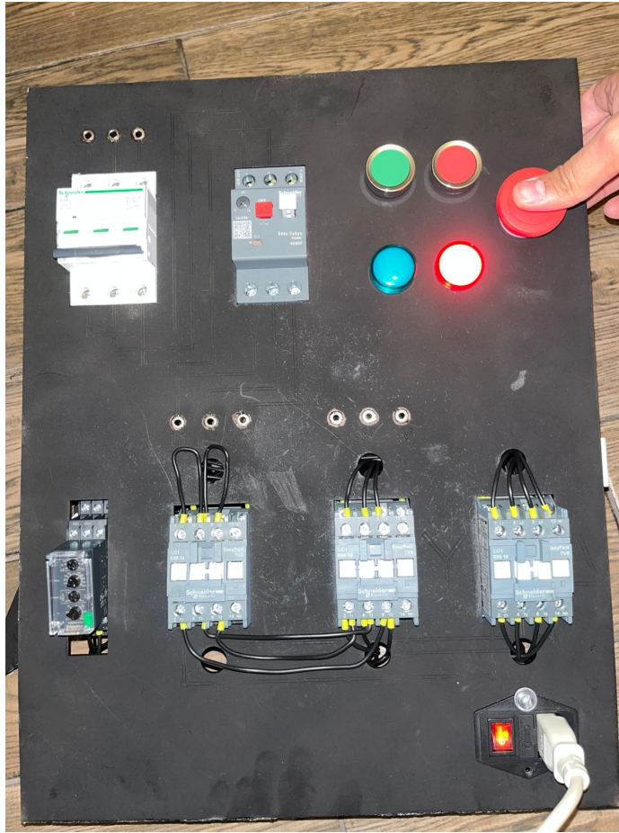
Figura 65. Funcionamiento correcto del arranque estrella-delta paro
