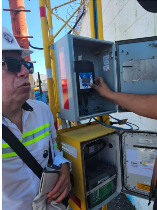
Figura 12. Mareógrafo utilizado para el levantamiento
