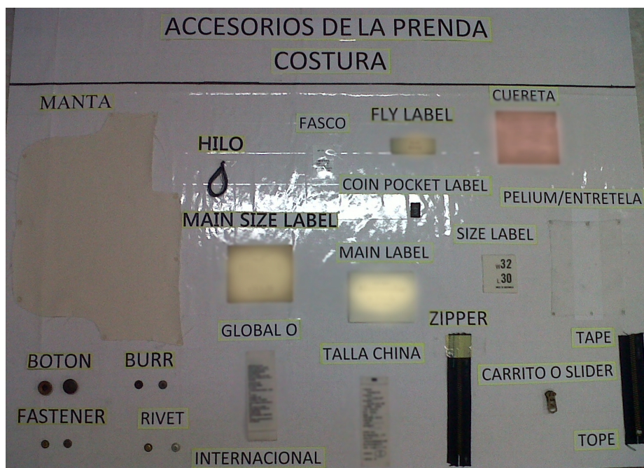
Gráfico 2. Materiales y accesorios de un pantalón de lona
