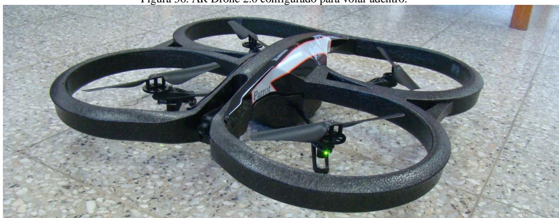
Figura 36. AR Drone 2.0 configurado para volar adentro.
