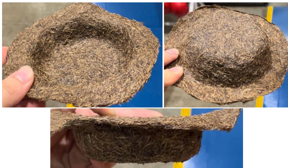
Figura 7. Prototipo plato de un solo uso elaborado a partir de fibra residual de palma africana
