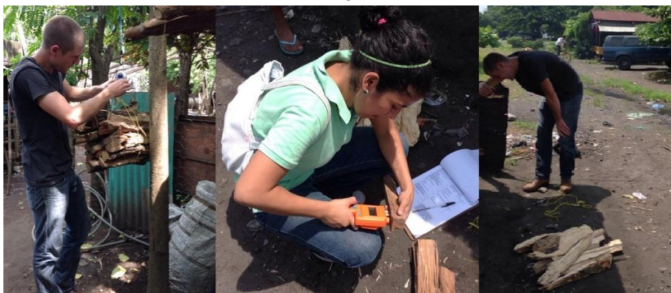
Gráfica 14. Proceso KPT: (a) Peso inicial. (b) Registro cant. de humedad. (c) Peso leña sobrante.
