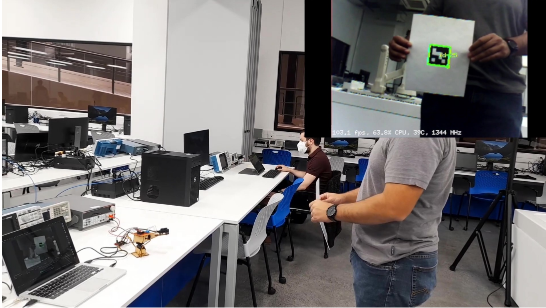
Figura 70: Pruebas de controlador IBVS usando ArUco Markers.
