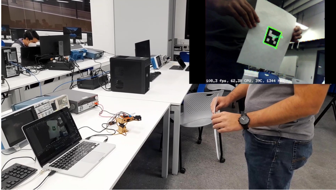
Figura 67: Pruebas de controlador PD usando ArUco Markers.
