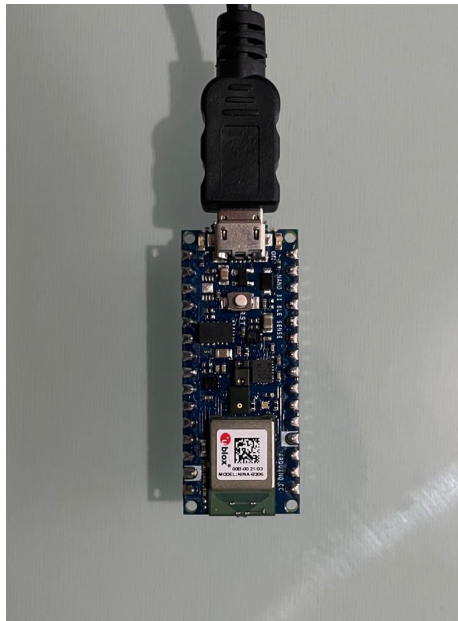
Figura 13: Arduino Nano 33 BLE Sense utilizado en el trabajo.
