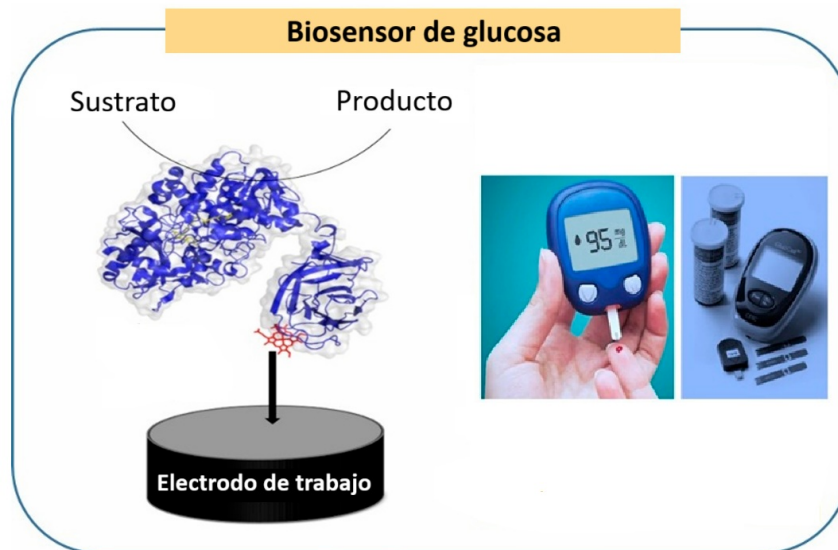
Figura 5. Biosensor electroquímico ampliamente utilizado hoy en día En la imagen se visualiza un biosensor electroquímico de glucosa, el cual hoy en día es uno de los biosensores maás completos y sofisticados. Modificado de [26].
