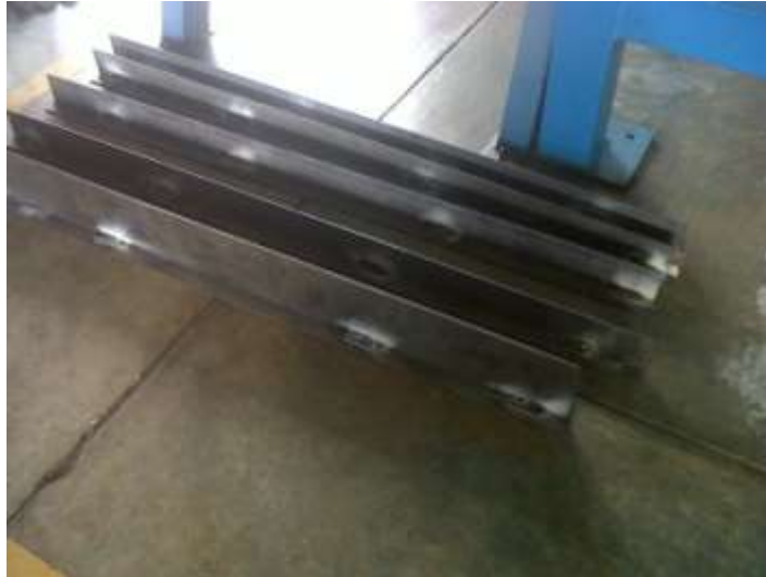
Figura No. 19 Placas deflectoras de 0.05m (2 plg.) y de 0.10m (4 plg.)
