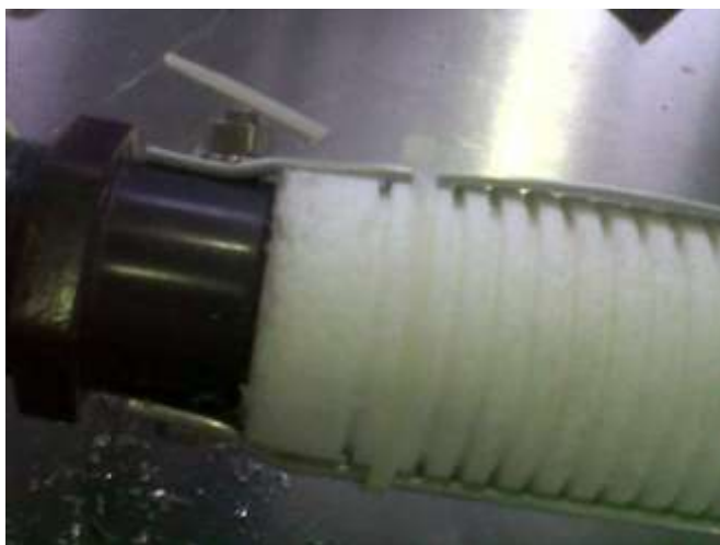
Figura No. 28 Tornillo de acero inoxidable y cincho de presión
