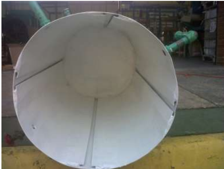
Figura No. 22 Cubrimiento de pintura epoxica
