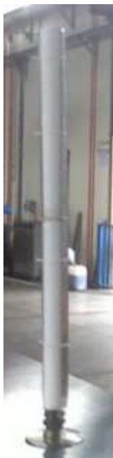
Figura No. 27 Filtro candela reconstruido
