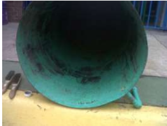
Figura No. 17 Limpieza y pulido de tanque de agitación
