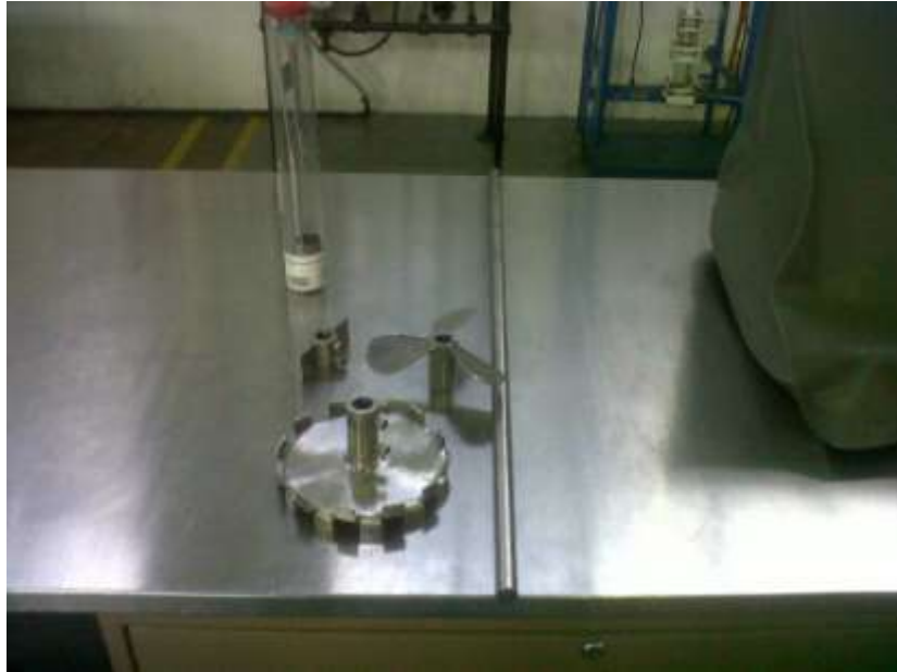
Figura No. 24 Agitador de paleta, hélice, disco y eje del sistema de agitación
