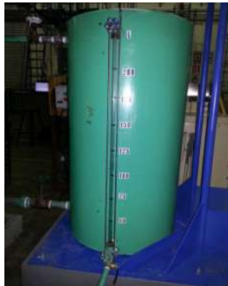
Figura No. 23 Medidor de nivel del tanque de agitación
