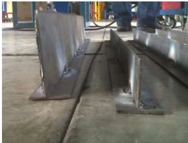
Figura No. 19 Placas deflectoras de 0.05m (2 plg.) y de 0.10m (4 plg.)
