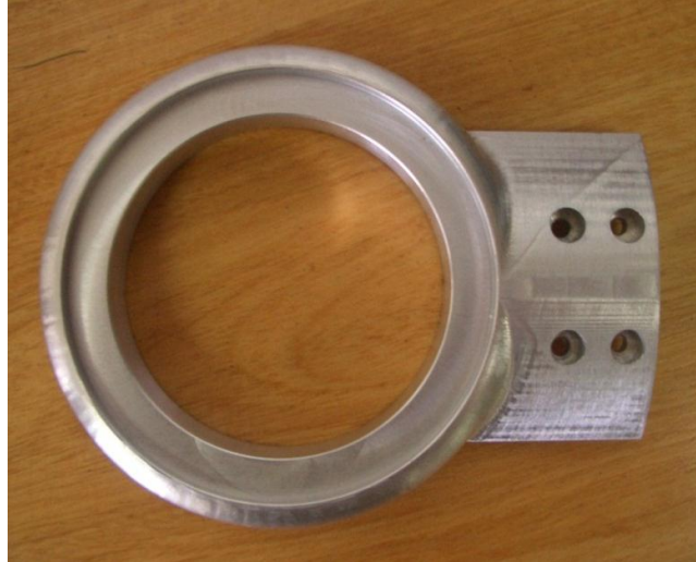
Ilustración 26. Soporte lateral después del último maquinado en la CNC
