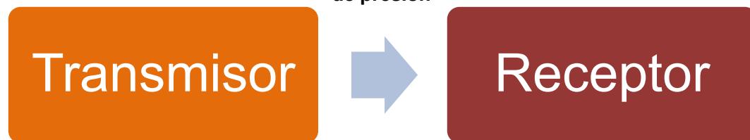
Ilustración 95. Topología point-to-point del sistema de control basado en puntos de presión
