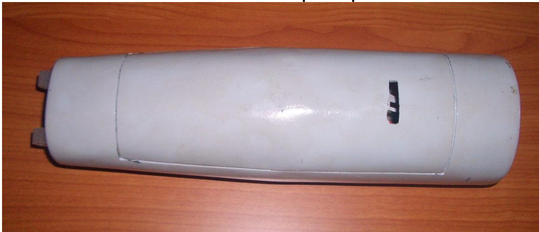
Ilustración 1. Estructura de antebrazo para la prótesis biónica de mano.
