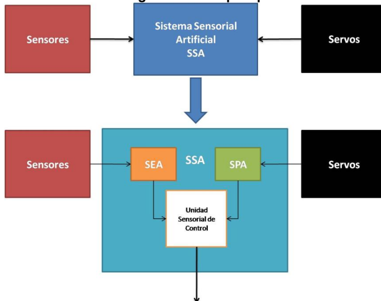
Ilustración 110. Diagrama de bloques preliminar del SSA
