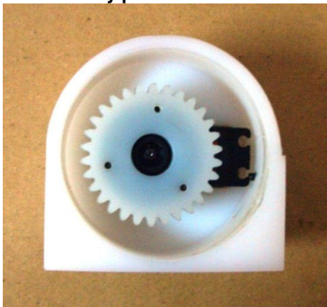
Ilustración 34. Servomotor y piñón instalado en la estructura central
