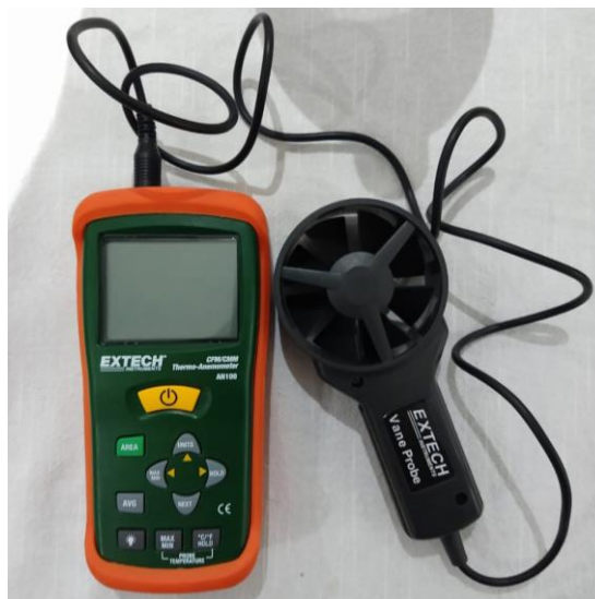
Ilustración 102. Anemómetro – Extech Instruments CFM Thermo-Anemometer.
