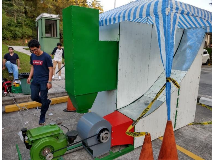
Ilustración 77. Implementación de ductos a cámara de secado – Trasero.
