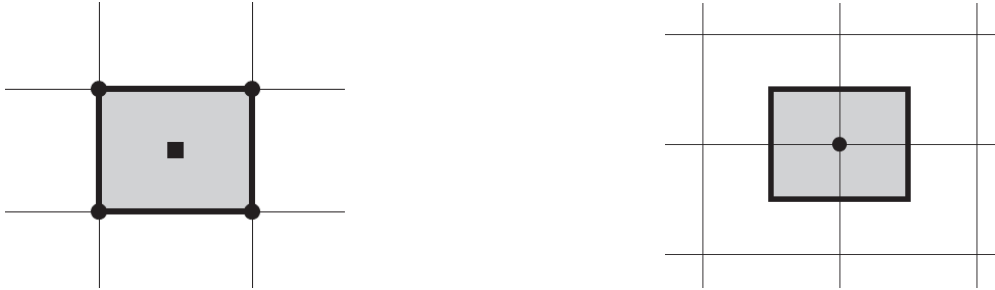
Ilustración 22. Volumen de control centrado en la celda (izquierda) y vértices de celda (derecha).
