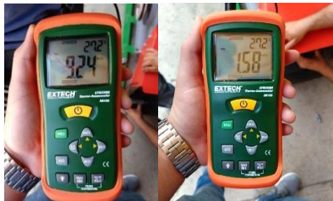
Ilustración 79. Velocidad de flujo a salida de ventilador, perímetro (izquierda), centro (derecha).
