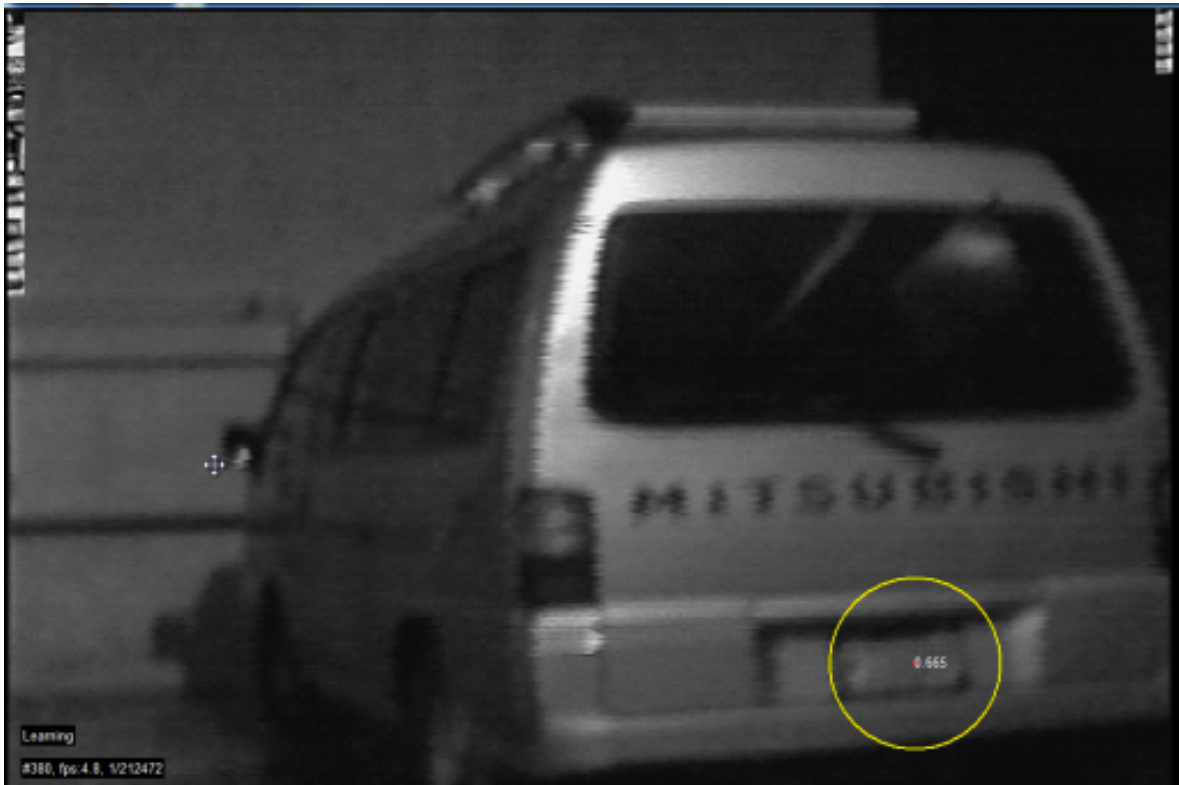
Figura No. 82 Sobrevuelo del UAV por el objeto aprendido y detectado por el algoritmo.
