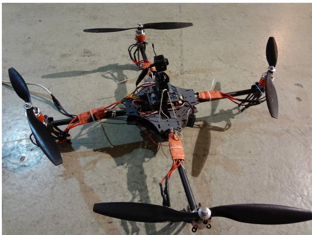
Figura No. 36 Vista lateral estructura final de fibra de carbono.
