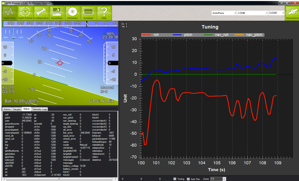
Figura No. 76 Re-ajuste de parámetros PID luego de primeras pruebas de vuelo.
