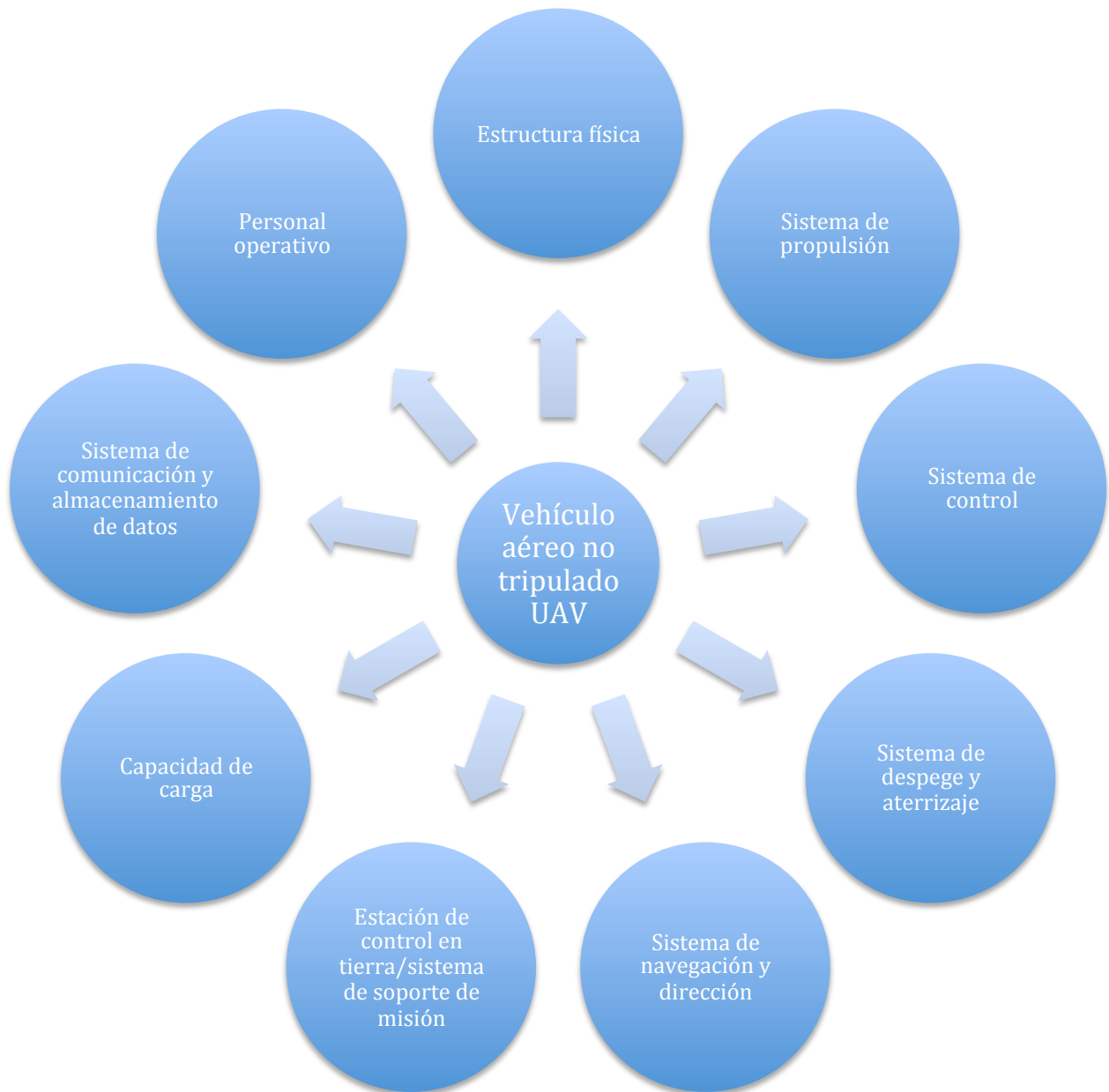
Figura No. 2 Principales subsistemas que integra un UAV
