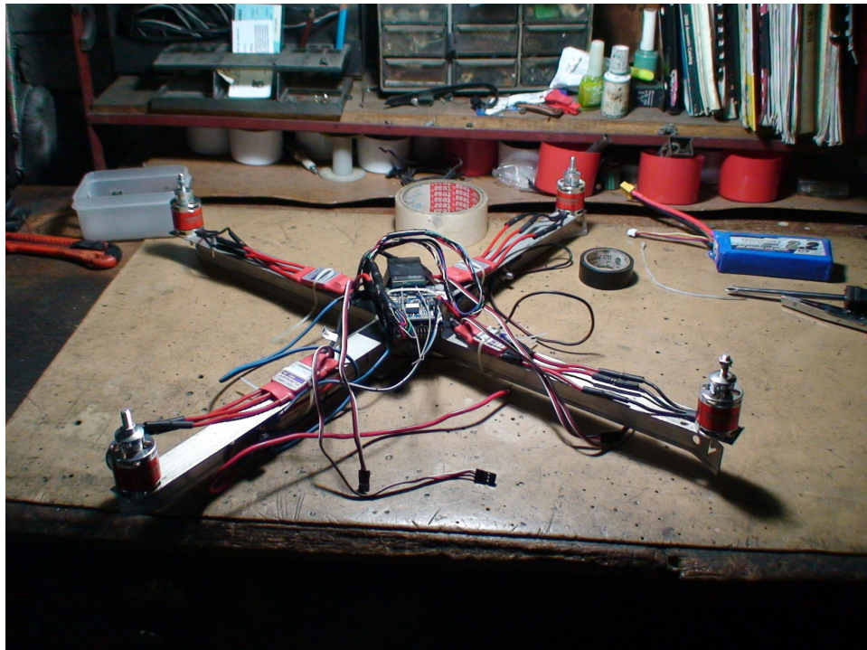
Figura No. 28 Segunda estructura dos reglas de aluminio.
