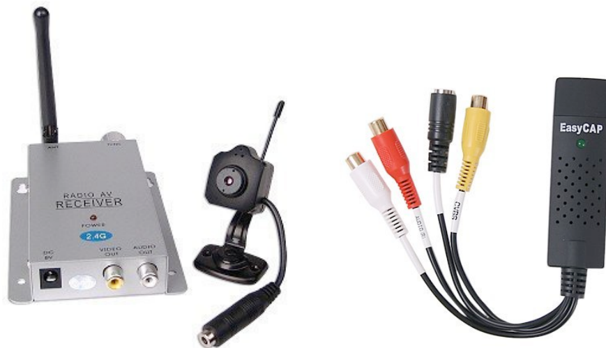
Figura No. 55 Sistema de video inalámbrico y tarjeta de captura de video.
