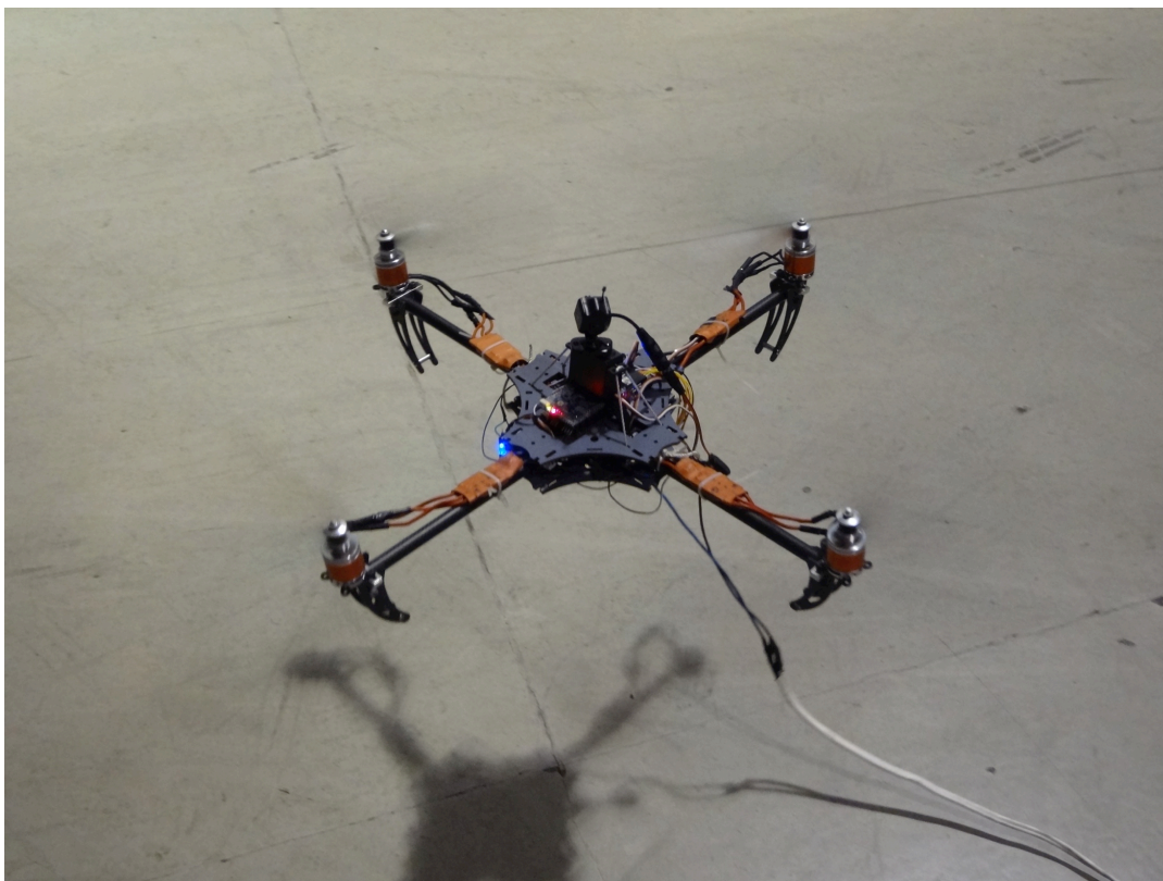
Figura No. 36 Vista lateral estructura final de fibra de carbono.
