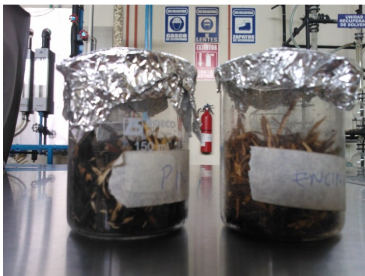
Figura No. 2: Proceso de impregnación por 48 horas con ácido Fosfórico 0.365M con madera pino y encino.
