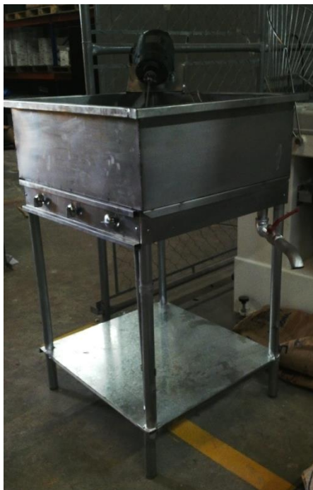
Figura No. 8. Tanque para realización de caramelo con agitación
