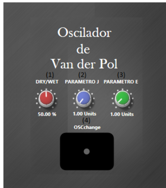
Figura 32: Interfaz GUI del efecto de audio basado en el oscilador de Van Der Pol
