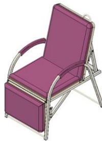
Figura 23. Agregado de mecanismos en parte superior y tubos de soporte
