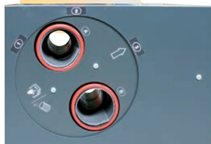
Unidad de conmutación: Conmutación automática de las sondas de extracción
