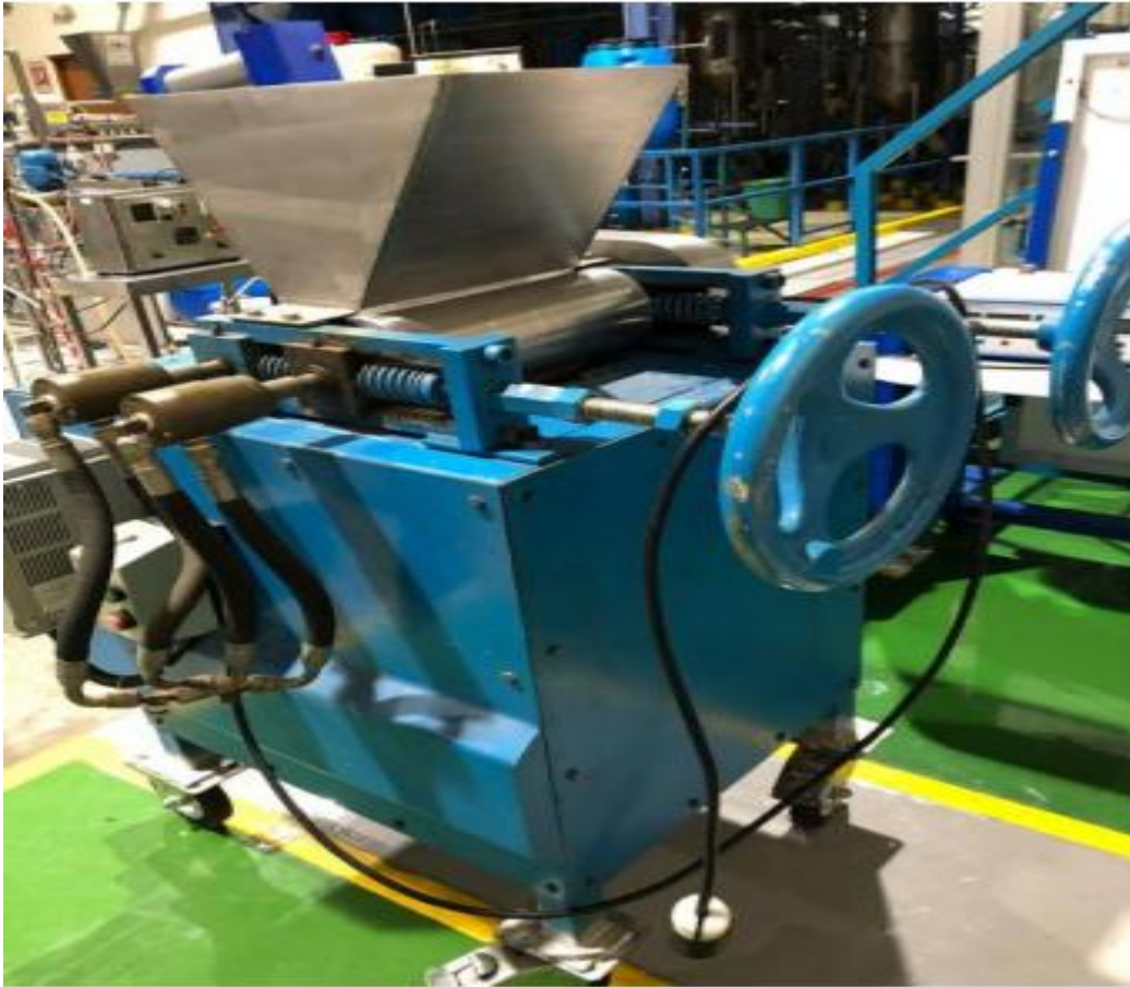
Figura 27 Molino de doble rodillo del laboratorio de Operaciones Unitarias de la Universidad del Valle de Guatemala
