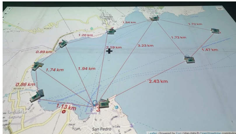
Figura 13. Implementación física de la red LoRa sobre mapa de prueba
