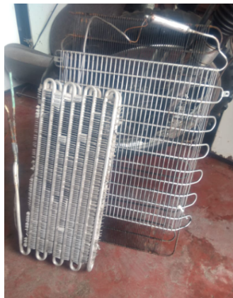
Figura 39: Evaporador y condensador utilizados
