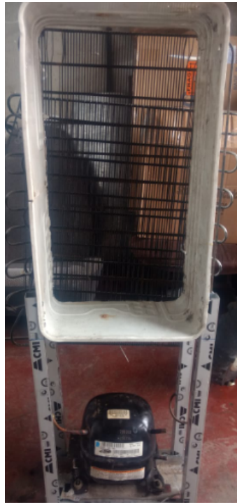
Figura 40: Colocación del condensador
