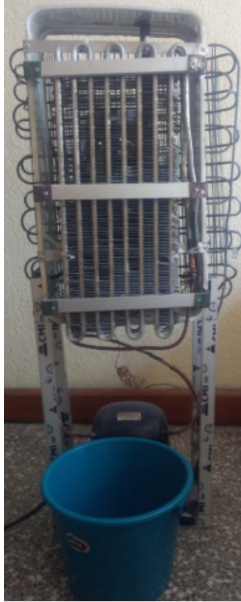
Figura 46: Resultado final de la construcción del proceso de deshumidificación
