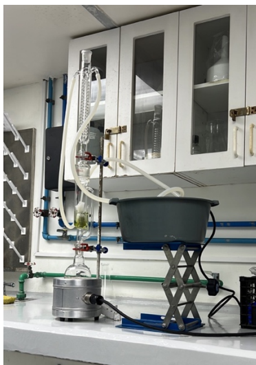
Figura 31. Sistema armado con recirculación de agua
