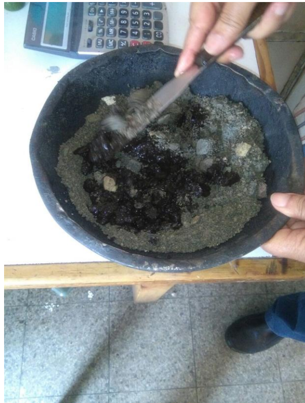
Figura No. 28 Preparación de briqueta de asfalto y agregados
