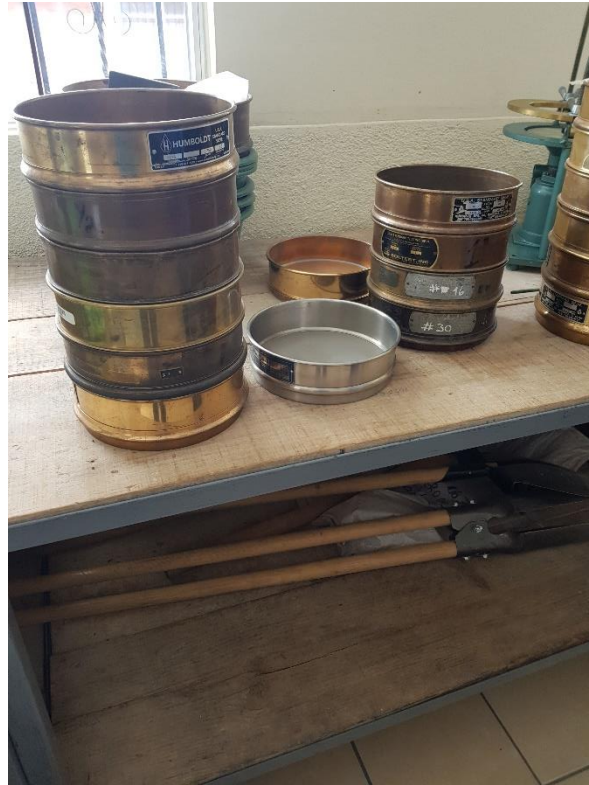
Figura No. 16 Tamices a utilizar para el ensayo de granulometría
