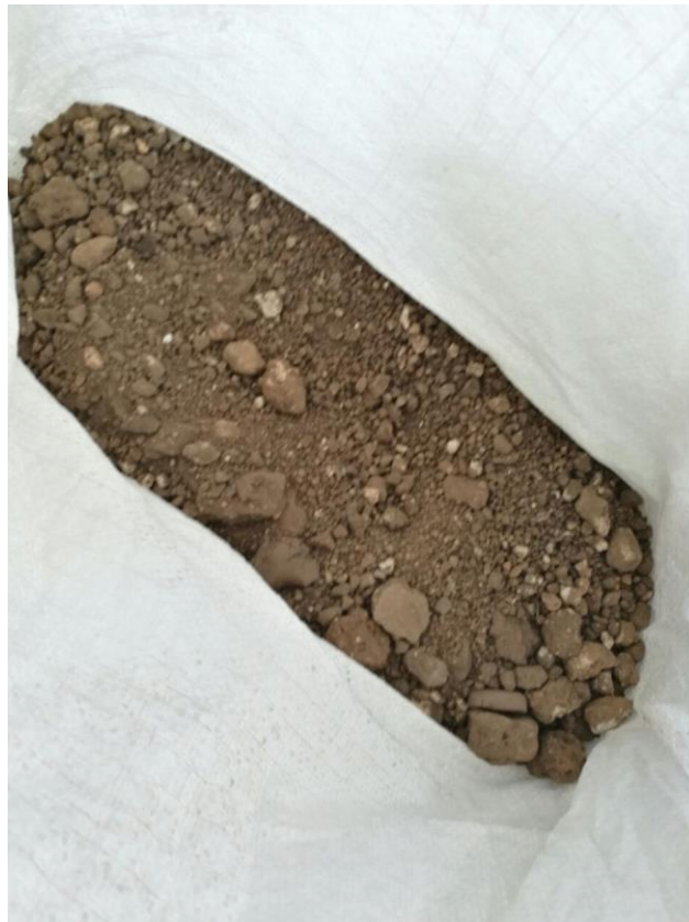
Figura No. 15 Suelo a ensayar para la base
