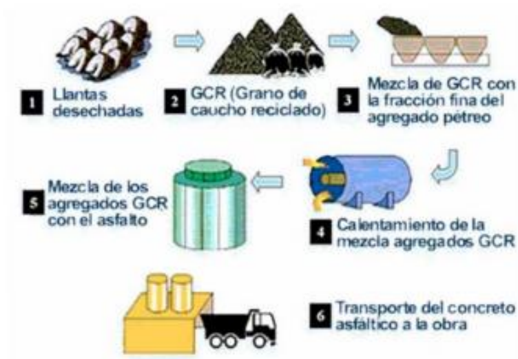
Figura No. 3 Proceso de adición del caucho vía seca
