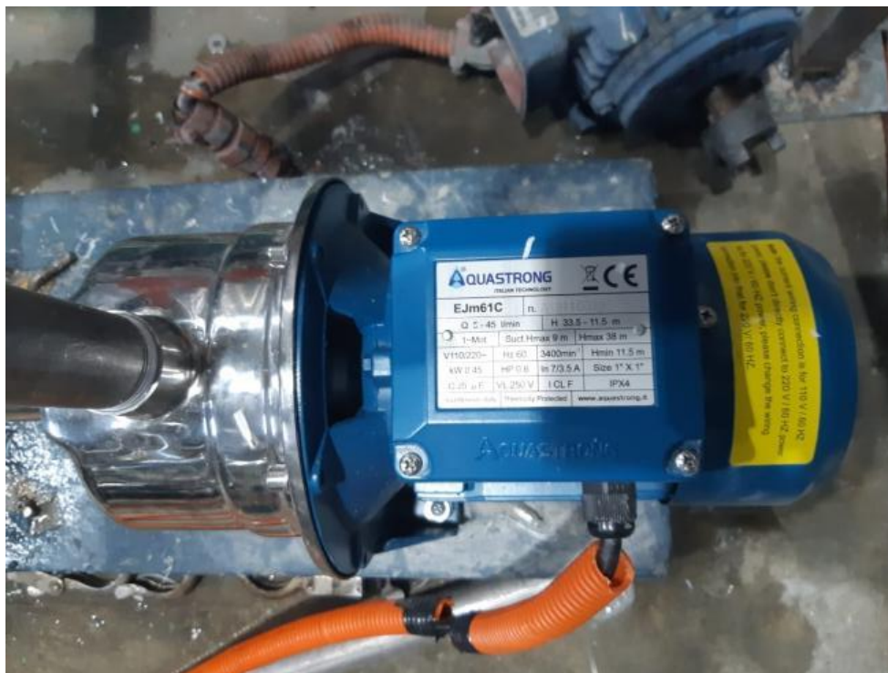
Figura 272. Bomba aurora analizada para bombeo de cerveza
