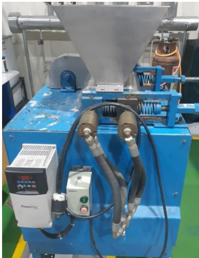
Figura 277. Molino de rodillos utilizado con separación de 2 mm a 30.8 rpm
