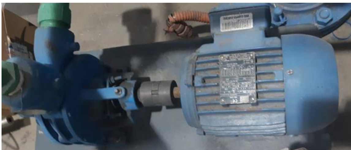
Figura 272. Bomba aurora analizada para bombeo de cerveza
