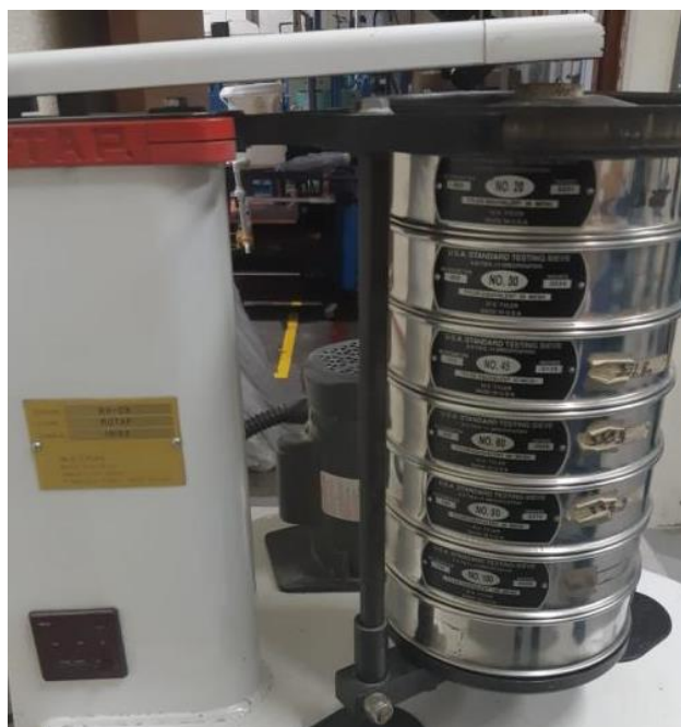
Figura 275. Tamizadora marca W.S. Tyler modelo RX-29
