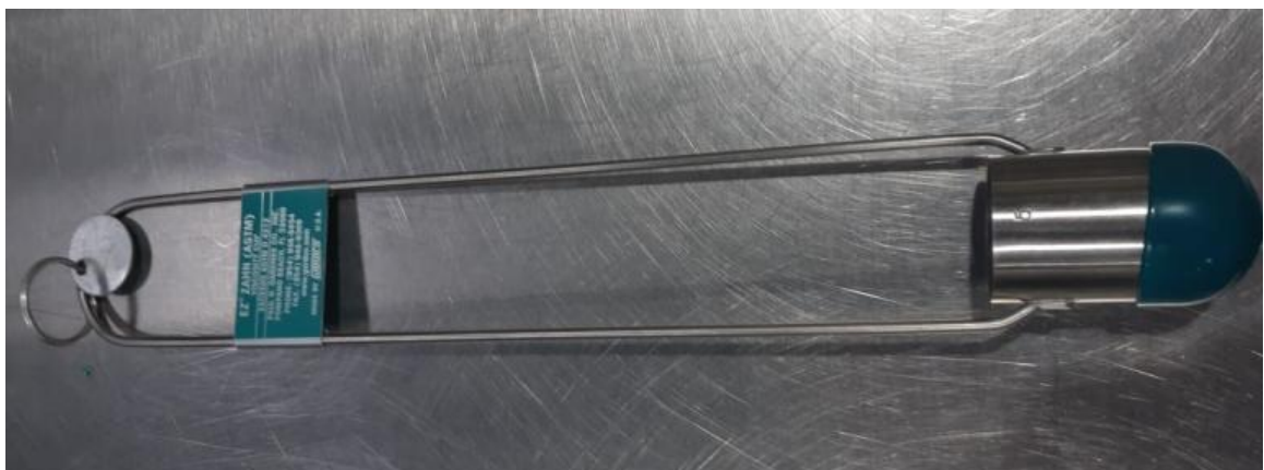
Figura 270. Viscosímetro marca Ez Zahn de copa 5
