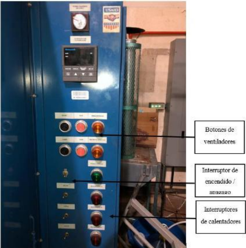
Cuadro 195. Datos técnicos del deshidratador de gabinetes del laboratorio de operaciones unitarias
