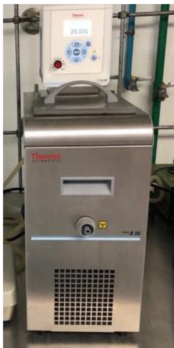
Figura 168. Baño térmico utilizado para mantener controlada la temperatura del inóculo
