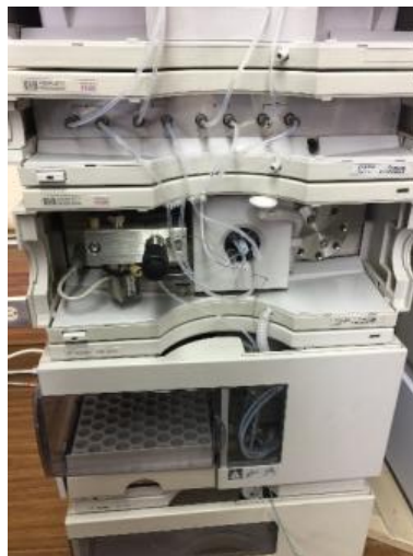
Figura 154: Cromatógrafo HPLC marca Agilent, 1,100 Series.
