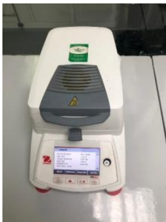
Figura 152: Balanza de humedad marca OHAUS, modelo MB 120.
