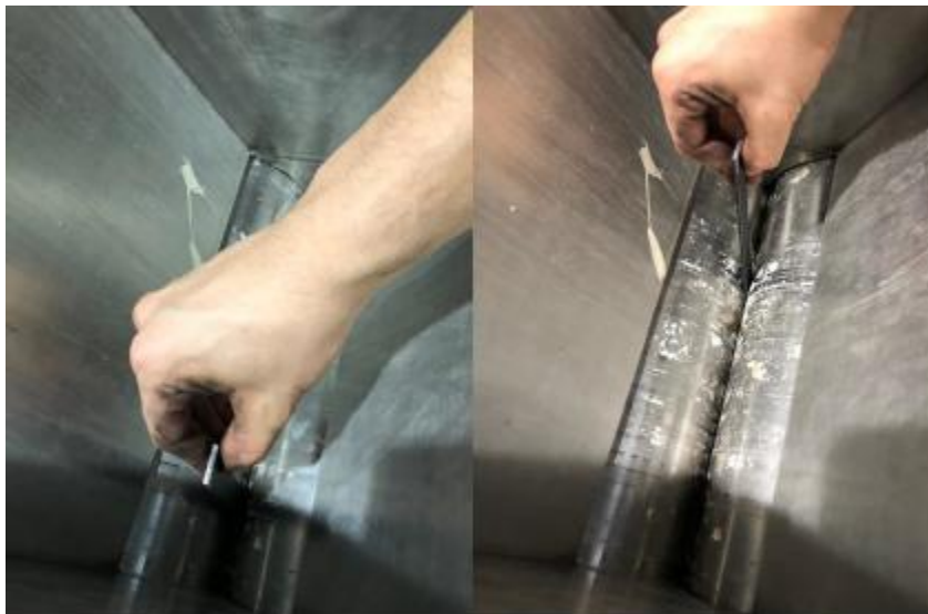
Figura 138: Ajuste de secador de rodillos con estándar referencia
