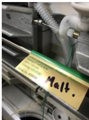
Figura 176. Columna Aminex HPX-87K utilizada en el HPLC
