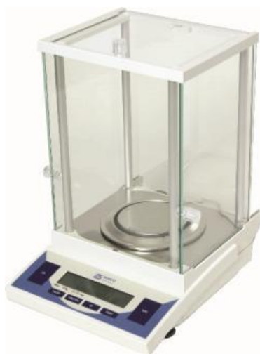
Figura 166. Balanza analítica BOECO Germany
