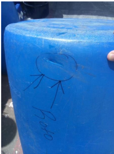
Figura 4. Rajadura de tonel por golpe
