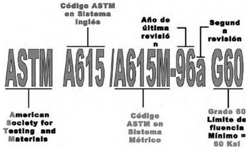
Figura 2. Designación aceros estructurales
