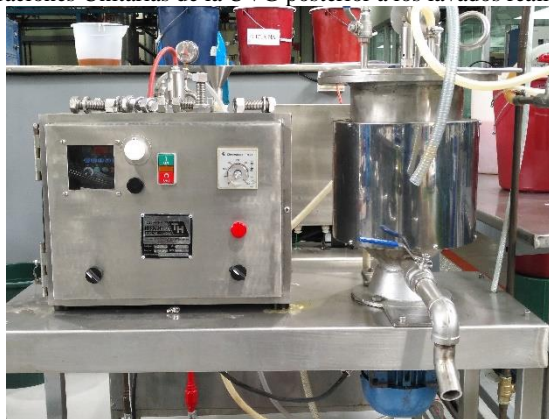
Figura 18. Reactor empleado para el secado del biodiésel producido en la planta demostrativa del Laboratorio de Operaciones Unitarias de la UVG posterior a los lavados realizados.
