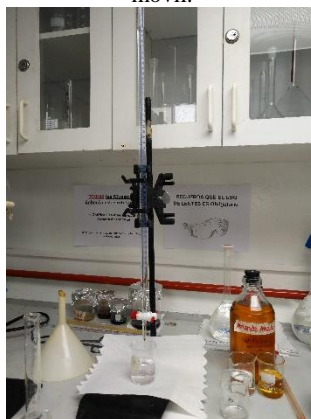
Figura 21. Sistema empleado para la determinación del número ácido del biodiésel obtenido en la planta demostrativa y móvil.
