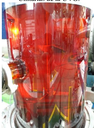
Figura 15. Biodiésel sin lavar libre de glicerina obtenido en la planta demostrativa del Laboratorio de Operaciones Unitarias de la UVG.
