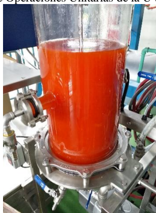
Figura 13. Inicio de la reacción entre el aceite usado y el metóxido de sodio en la planta demostrativa del Laboratorio de Operaciones Unitarias de la UVG.
