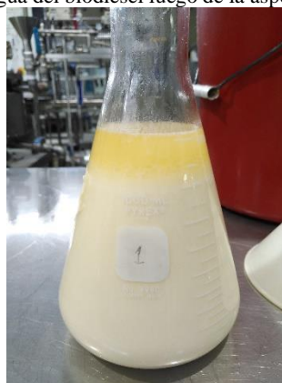
Figura 17. Separación del agua del biodiésel luego de la aspersión en el tanque de lavado.
