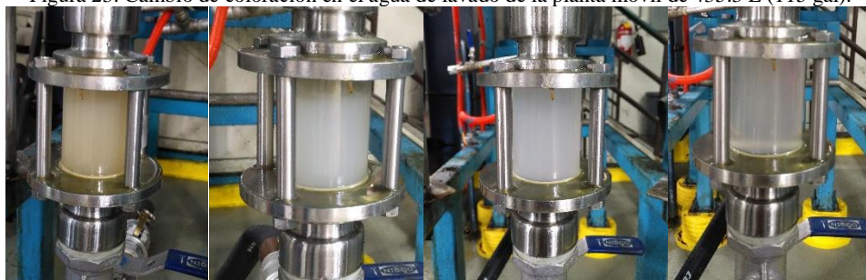
Figura 23. Cambio de coloración en el agua de lavado de la planta móvil de 435.3 L (115 gal).
