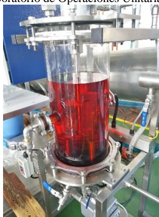
Figura 14. Separación de la glicerina del tanque de reacción al tanque de almacenamiento de la planta demostrativa de 18 L del Laboratorio de Operaciones Unitarias de la UVG.
