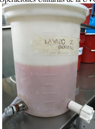
Figura 16. Separación del agua del biodiésel luego de la aspersión en el tanque de lavado del Laboratorio de Operaciones Unitarias de la UVG.
