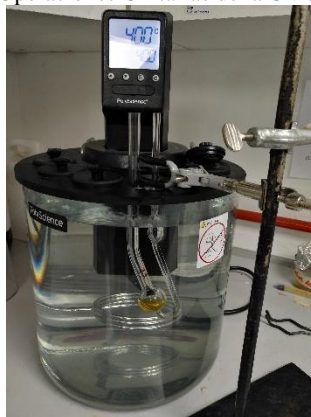
Figura 22. Sistema empleado para la determinación de la viscosidad del biodiésel y aceite del Laboratorio de Operaciones Unitarias de la UVG.
