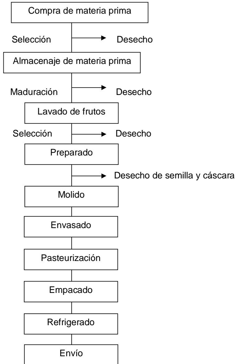
Figura 2: Diagrama de flujo del proceso para obtener pulpa congelada
