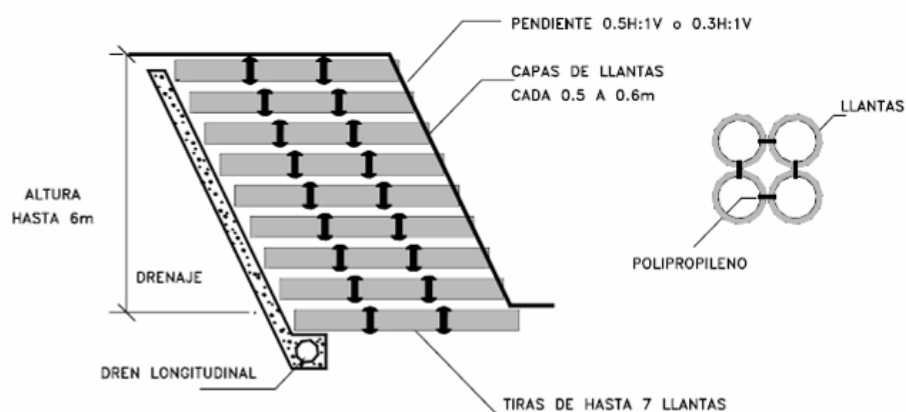
Figura VI-8 Esquemas de un muro en llantas usadas con arreglo total en las llantas
