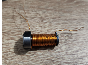
Figura 37: Tercera iteración de solenoide con dos bobinas en paralelo
