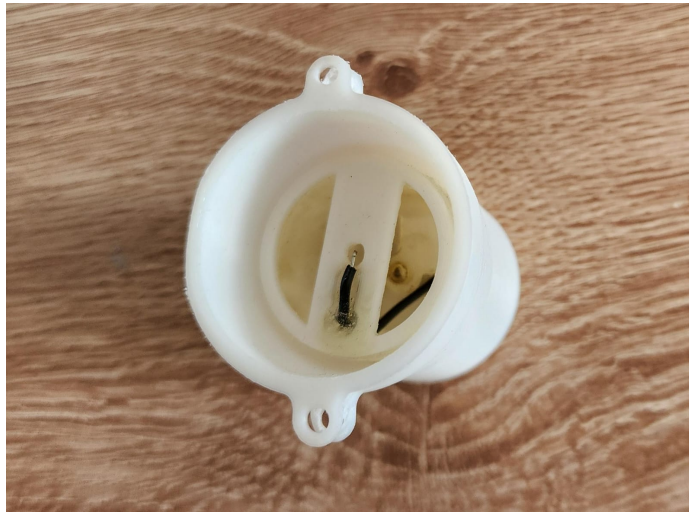
Figura 25: Pistola interna montada en cámara de ionización
