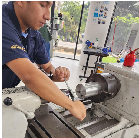
Figura 23: Realización de roscas para iteración 2
