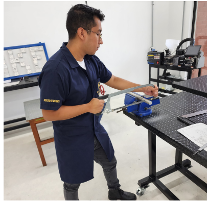
Figura 40: Corte de cilindro para acople tanque-bloque de paso
