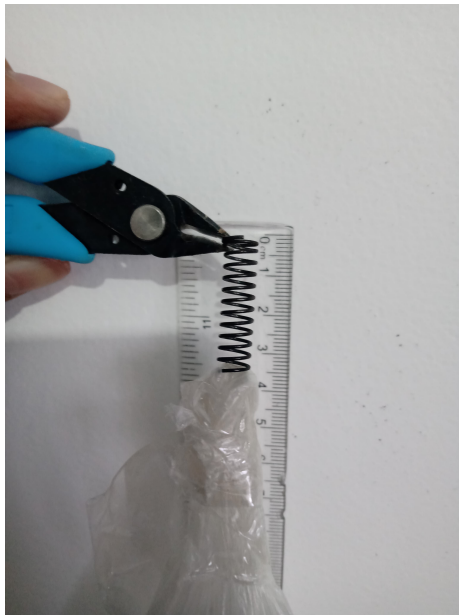
Figura 32: Resorte con una carga aplicada
