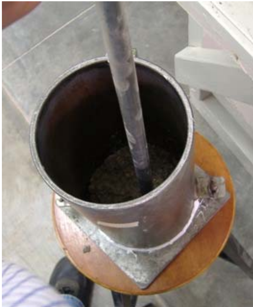
Imagen 9: Compactado de concreto
