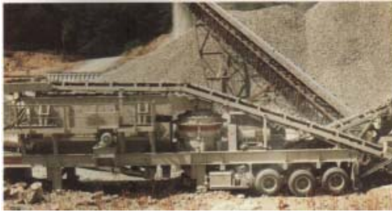
FIGURA 2: Elemento secundario con criba vibratoria, marca nordberg, en producción.
