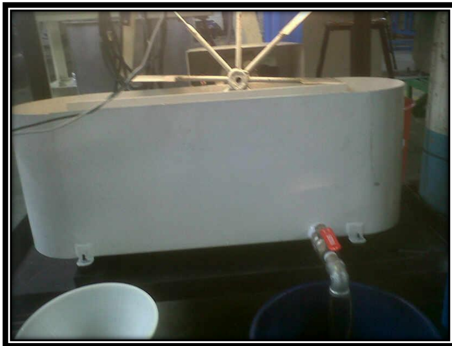
Fotografía No. 21 Descargando biorreactor de pileta de 15 L ubicado en el Laboratorio de Operaciones Unitarias de la Universidad del Valle de Guatemala
