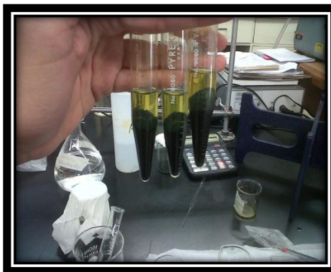
Fotografía No. 35 Microalga extracción Método Bligh&Dyer
