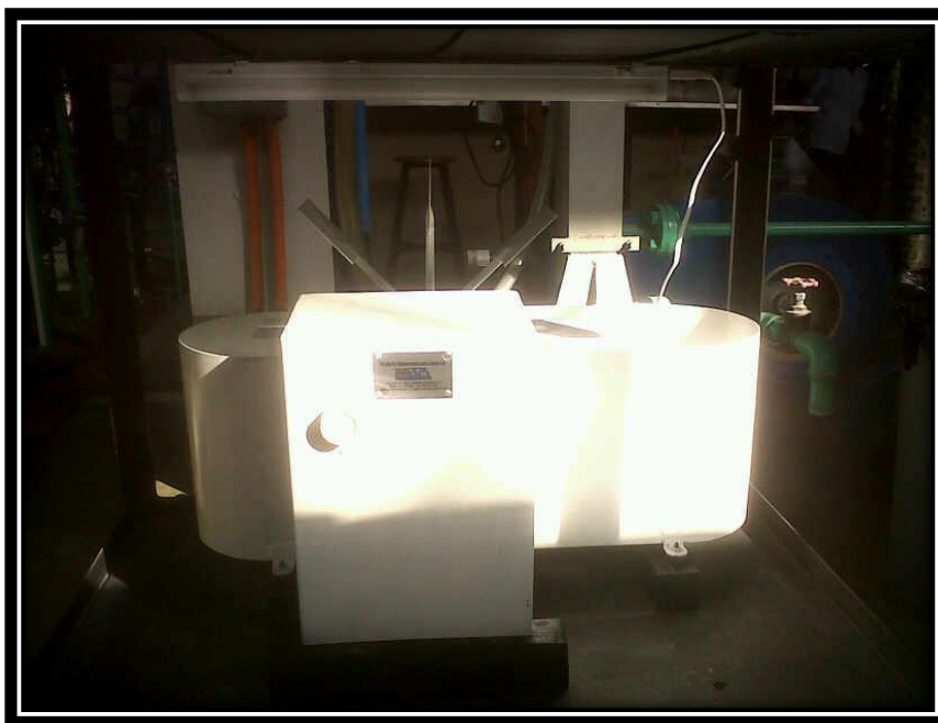
Fotografía No. 19 Biorreactor de pileta de 15 L con lámpara fluorescente integrada ubicado en el Laboratorio de Operaciones Unitarias de la Universidad del Valle de Guatemala
