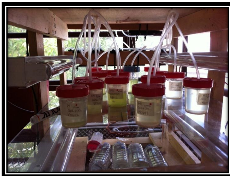
Fotografía No. 12 Sistema inicial para reproducción de microalgas
