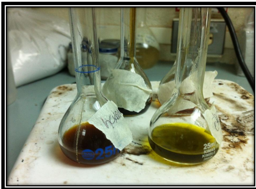
Fotografía No. 67 Saponificación en proceso de análisis de ácidos grasos
