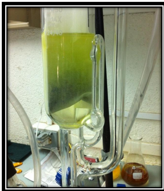
Fotografía No. 64 Cámara de extracción Soxhlet del Laboratorio de Operaciones Unitarias de la Universidad del Valle de Guatemala
