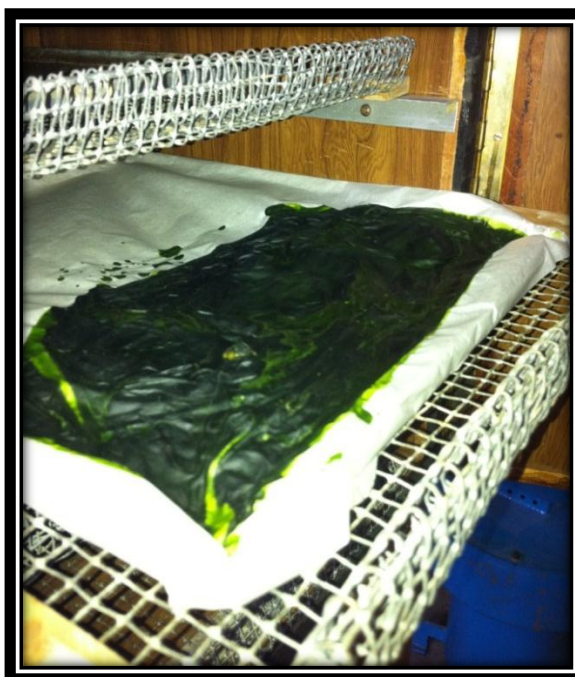
Fotografía No. 60 Secado de algas en secador de bandejas del Laboratorio de Operaciones Unitarias de la UVG
