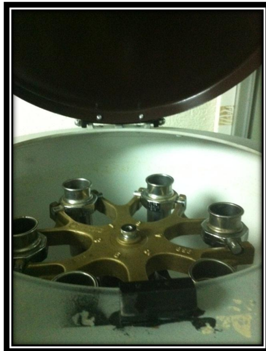
Fotografía No. 58 Separación de algas en la centrífuga IEC HN-SII del Laboratorio de Operaciones Unitarias de la UVG
