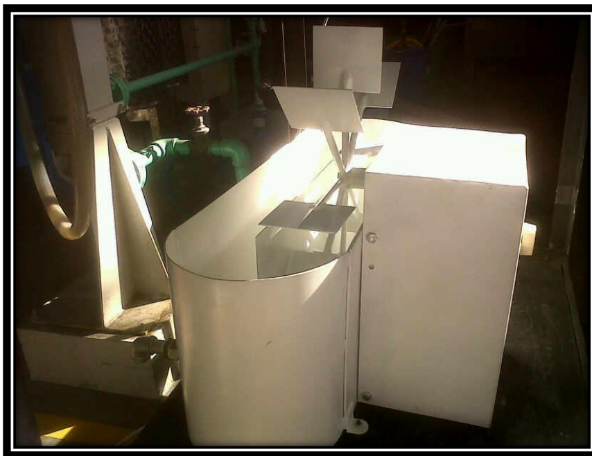
Fotografía No. 20 Vista lateral del biorreactor de pileta de 15 L ubicado en el Laboratorio de Operaciones Unitarias de la Universidad del Valle de Guatemala
