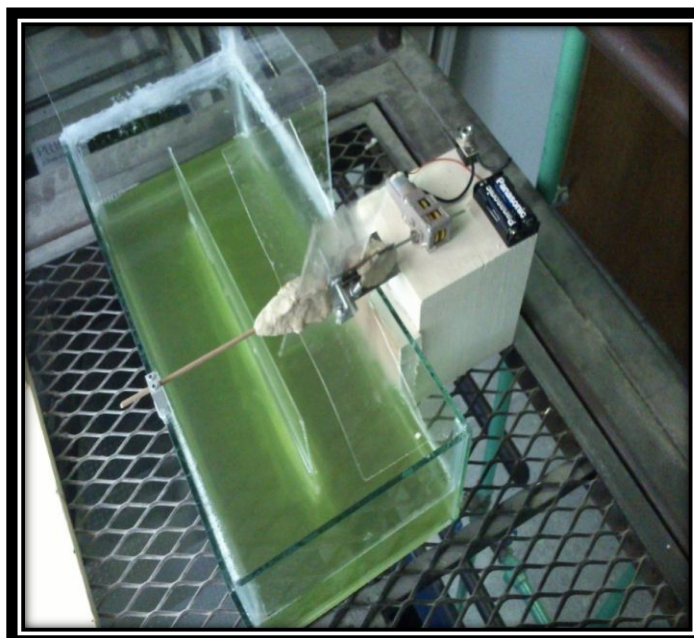
Fotografía No. 2 Reactor tipo estanque abierto ubicado en el Laboratorio de Operaciones Unitarias en la Universidad del Valle de Guatemala
