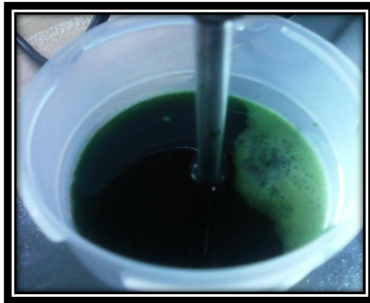
Fotografía No. 9 Cavitación en una muestra de microalgas del Lago de Amatitlán después de 5 minutos de tratamiento ultrasónico
