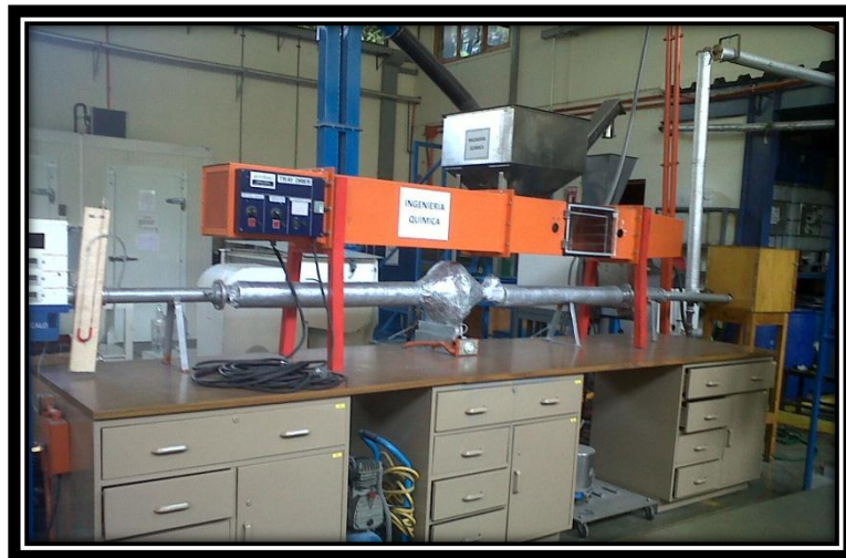
Fotografía No. 56 Secador a través de un tubo con aire, Laboratorio de Operaciones Unitarias
