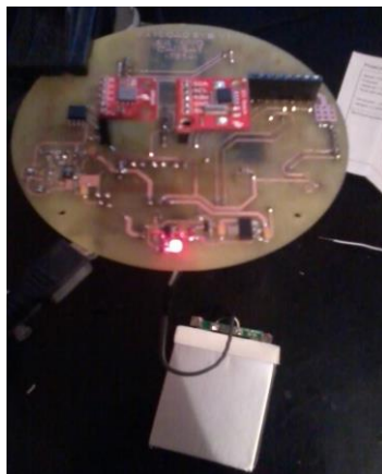
Figura No. 136. Primer prototipo del circuito impreso del Sistema Electrónico integrado de la carga útil. Izquierda: Vista trasera. Derecha: Vista frontal y antena de XBEE.
