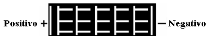
Figura No. 22. Polaridad de los módulos PowerFilm (Celdas Solares Flexibles)
