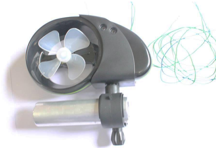
Figura No. 147. Hymini colocado en tubo de aluminio con cables de salida.
