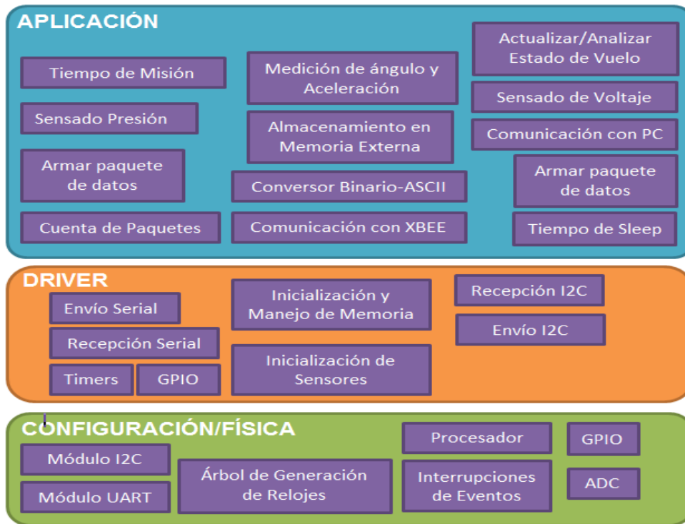
Figura No. 109. Modelo de capas del software de carga útil.
