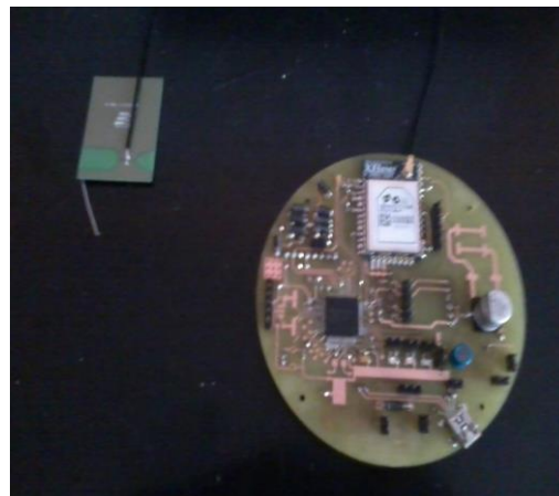
Figura No. 136. Primer prototipo del circuito impreso del Sistema Electrónico integrado de la carga útil. Izquierda: Vista trasera. Derecha: Vista frontal y antena de XBEE.
