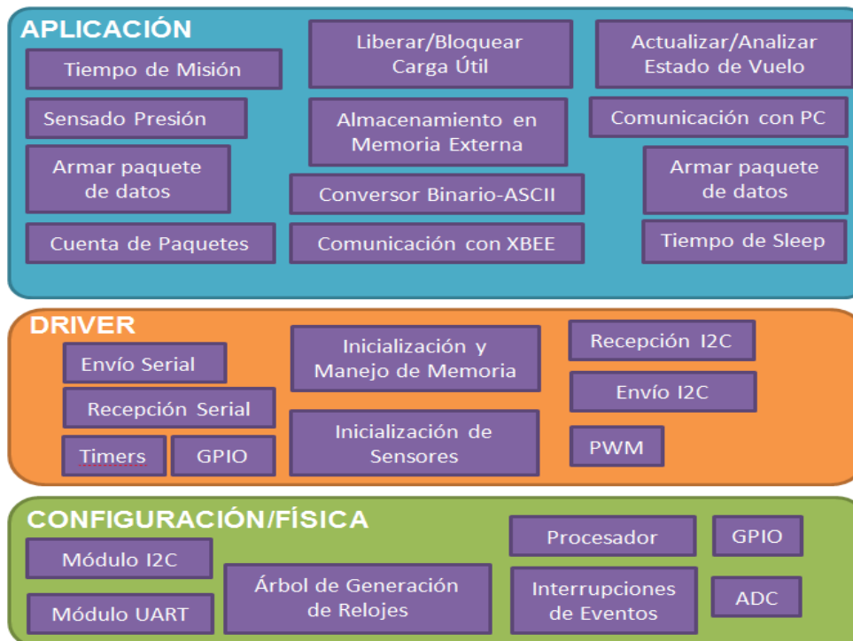
Figura No. 110. Modelo de capas del software de contenedor.
