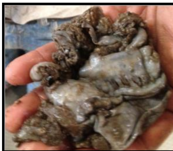
Ilustración No. 67 – Polisacárido encontrado en el fondo de la entrada de jugo, en el tanque de jugo diluido del tándem B.
