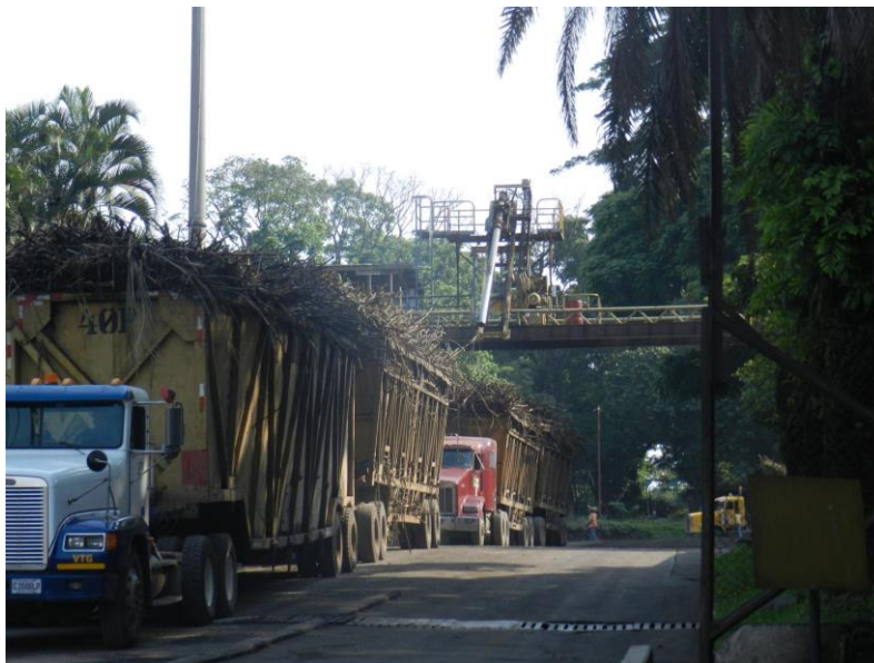
Ilustración No. 22 – Toma de muestra en Core Sampler .
