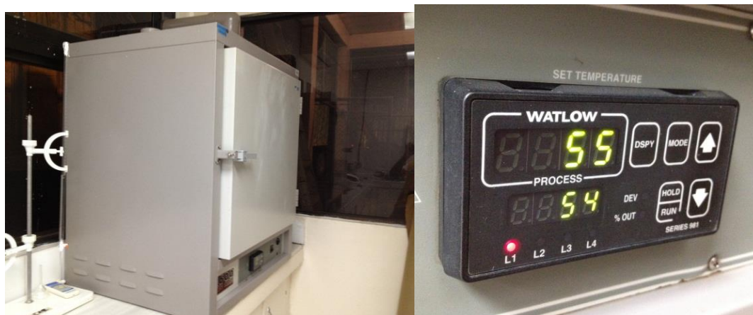
Ilustración No. 39 – Sistema utilizado para la incubación de las muestras a 55°C.
