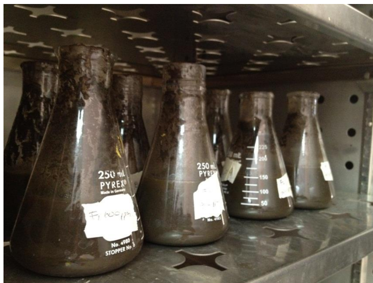
Ilustración No. 41 – Método para la medición del PH inicial, a las tres y cuatro horas de incubación.
