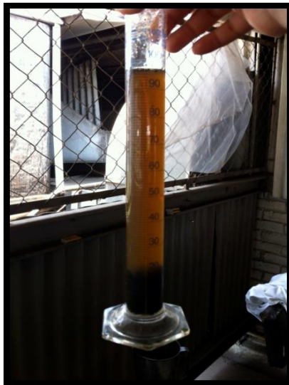
Ilustración No. 46 – Jugo clarificado y proporción en método a escala laboratorio.
