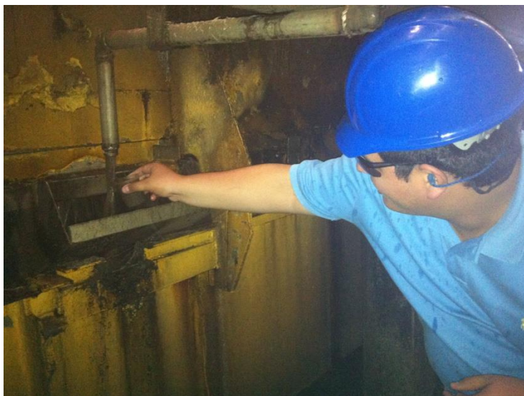
Ilustración No. 86 – Recolectando muestra del tanque de jugo diluido del tándem.
