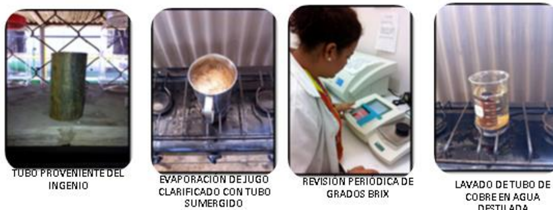
Ilustración No. 45 – Simulación a escala laboratorio del proceso de evaporación.
