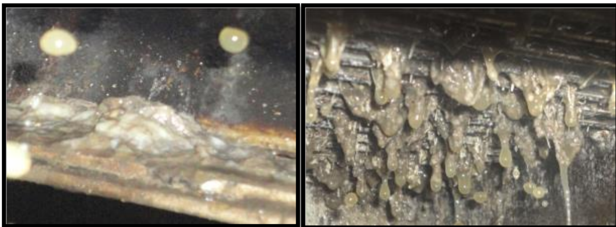
Ilustración No. 68 – Polisacáridos encontrados en el colador del tanque de jugo diluido del tándem B.
