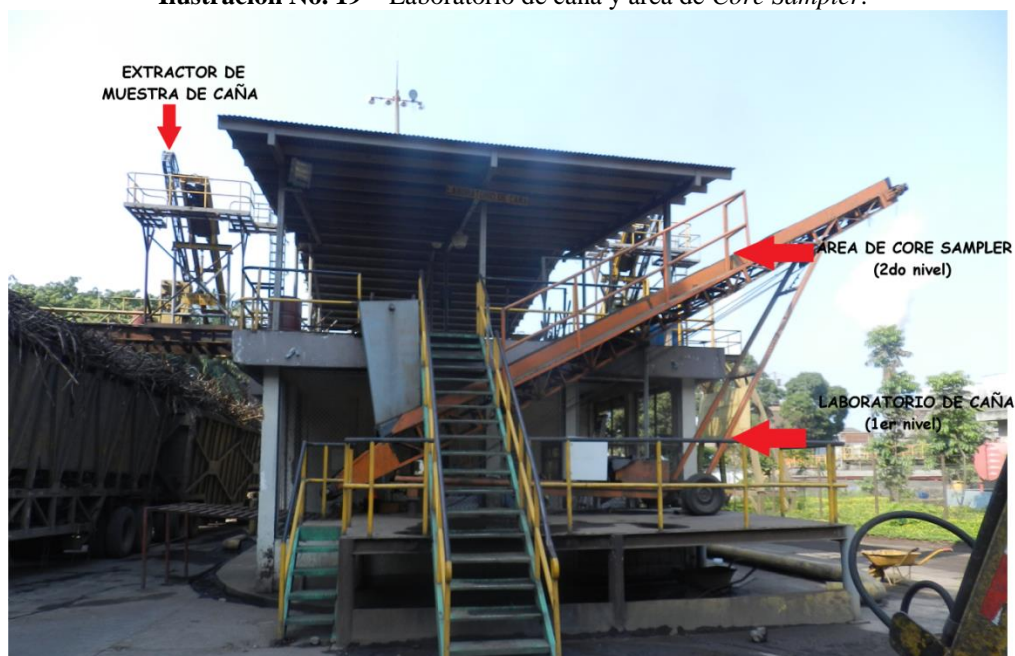
Ilustración No. 19 – Laboratorio de caña y área de Core Sampler .
