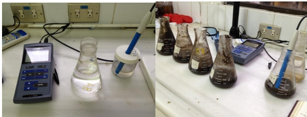
Ilustración No. 41 – Método para la medición del PH inicial, a las tres y cuatro horas de incubación.
