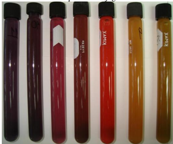
Ilustración No. 21 – Cambio de color que sufre el jugo de caña en el test de resazurina.
