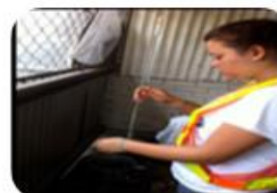
ADICIÓN DE FLOCULANTE
