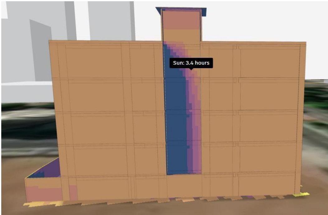
Fachada no crítica Noreste. Nota: Elaboración propia.
