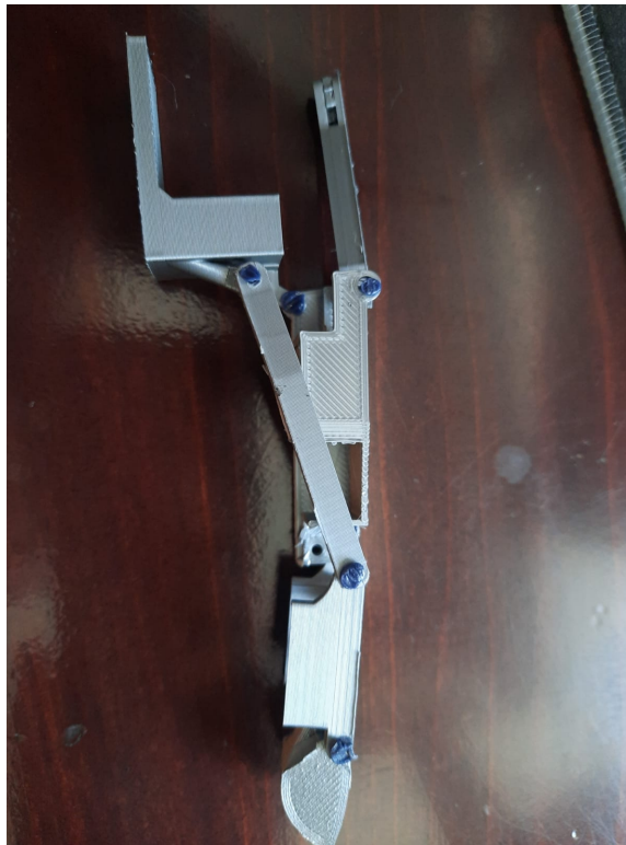
Figura 31: Imagen de prototipo de dedo impreso.
