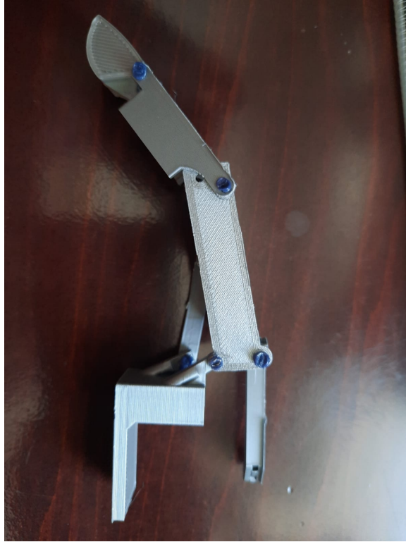
Figura 32: Imagen de prototipo de dedo impreso.
