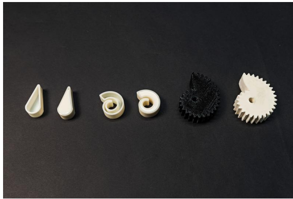
Figura 2. Combinación de impresión 3D y vertido de resina
