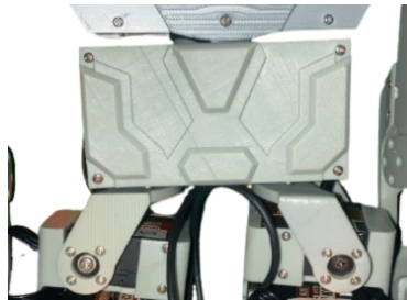
Figura 18. Prototipo final de la cintura fabricado en resina.
