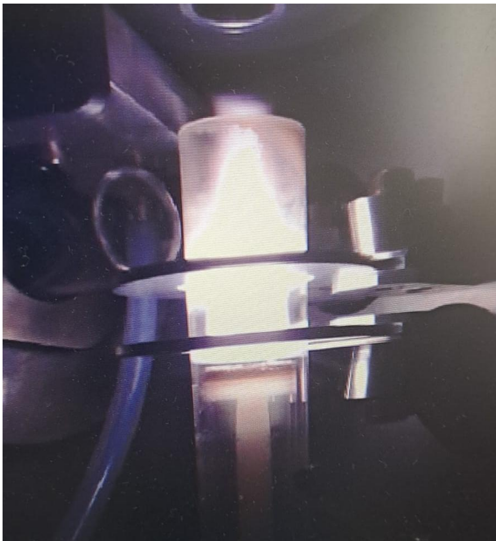
Figura 5. Imagen del plasma de argón en forma de antorcha
