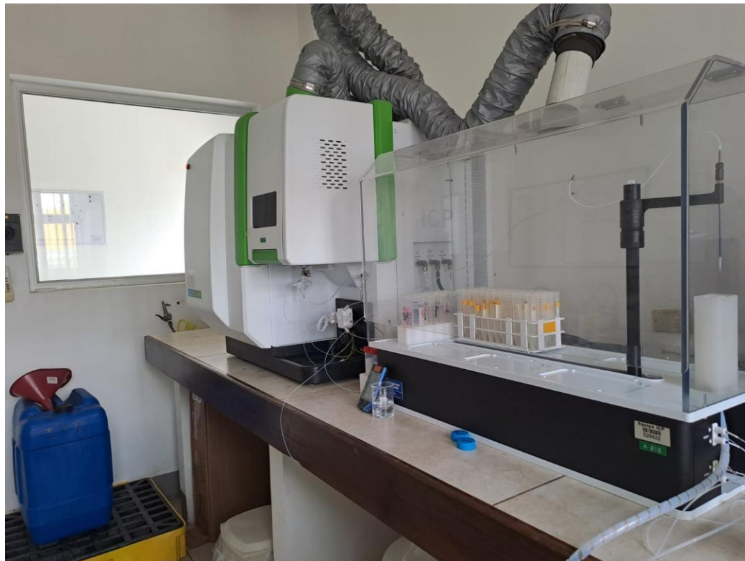
Figura 3. Imagen del equipo de emisión óptica con plasma acoplado inductivamente (ICP-OES) utilizado para el trabajo de graduación
