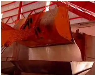
Ilustración 15: Introducción de materia prima en el trompo mezclador
