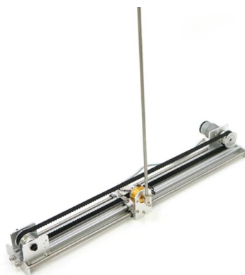
Figura 3: Péndulo invertido construido
