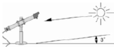
Ilustración 35. Altura elementos que proyecten sombra según altura angular del sol.
