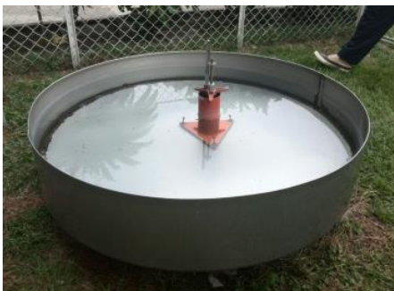
Ilustración 49. Tanque de evaporación.
