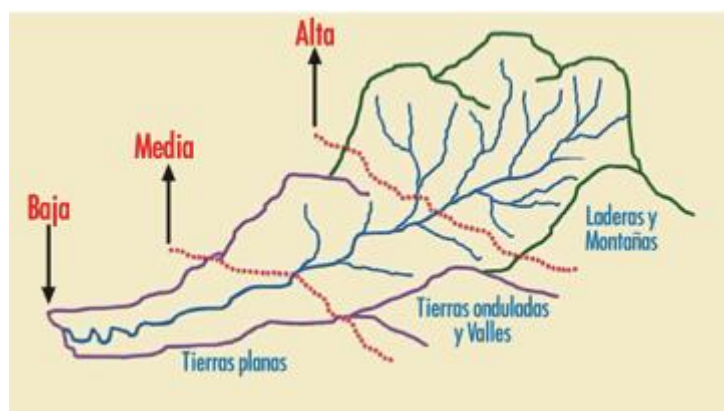
Ilustración 74. Partes de una cuenca con base en su altura.
