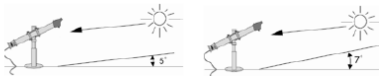
Ilustración 36. Altura otros elementos que proyecten sombra según altura angular del sol.
