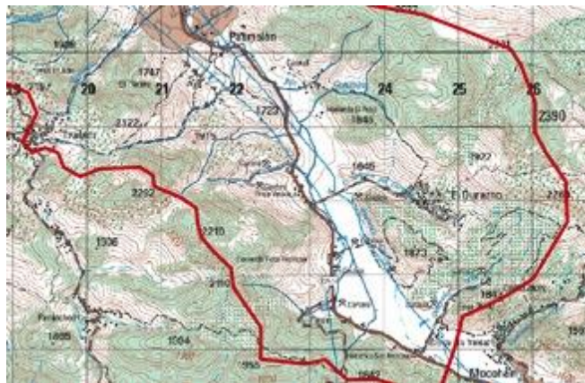
Ilustración 76. Método tradicional de trazo de la delimitación de cuenca, utilizando divisorias.
