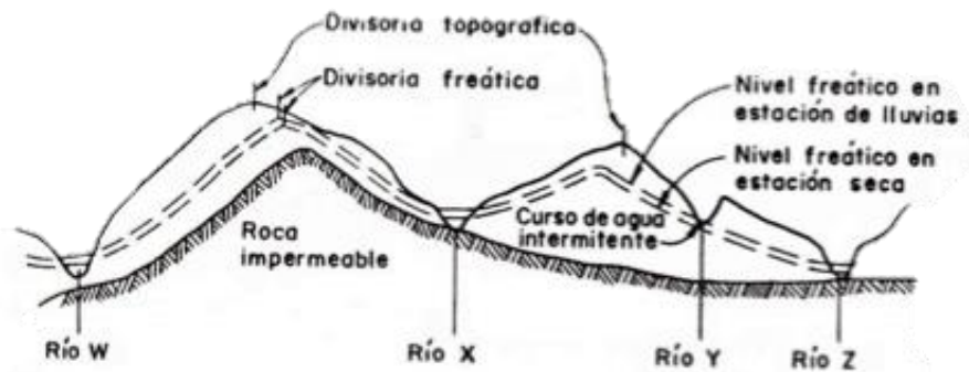
Ilustración 75. Corte transversal de una cuenca hidrográfica.
