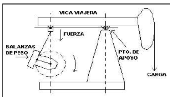
Figura No. 7 -Unidad de bombeo convencional
