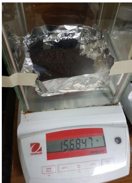
Figura 24. Separación y pesaje de la fase sólida.
