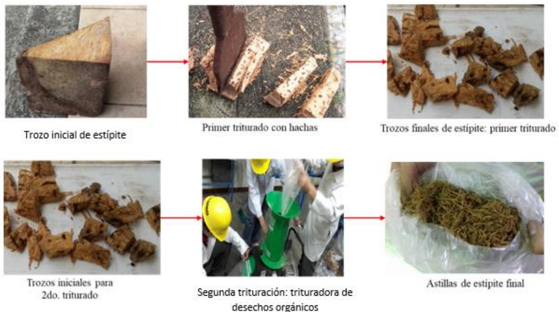
Figura 221. Proceso de trituración seguido para el triturado de estípite a nivel laboratorio.
