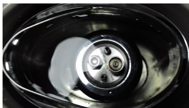
Figura 26. Bomba calorimétrica para la determinación del poder calorífico.
