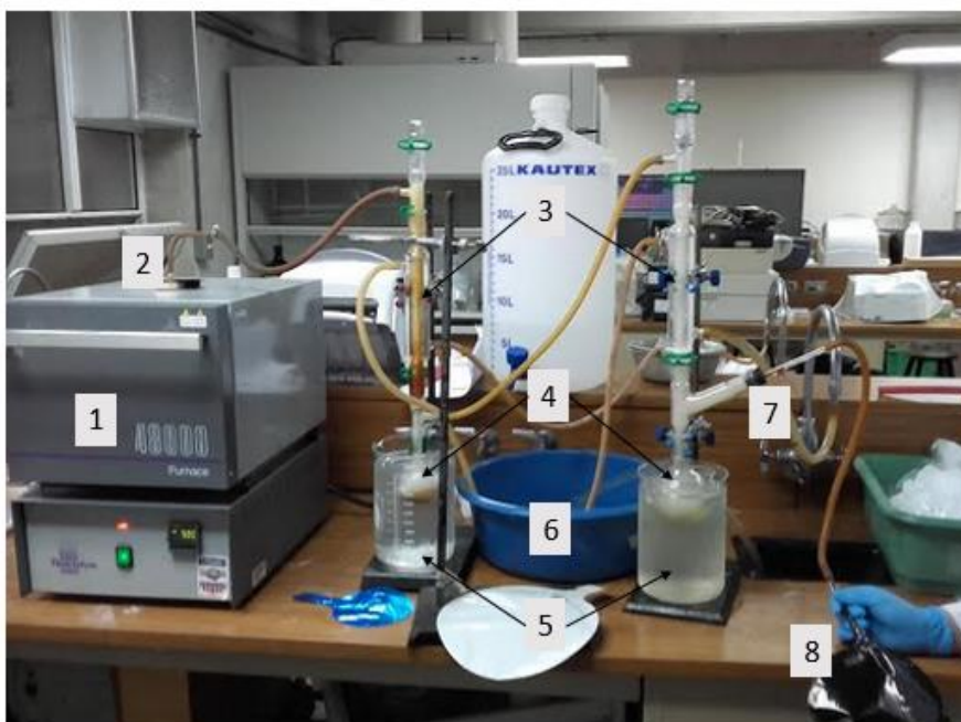
Figura 29. Sistema de pirólisis a escala laboratorio para la prueba 2 a 4.
