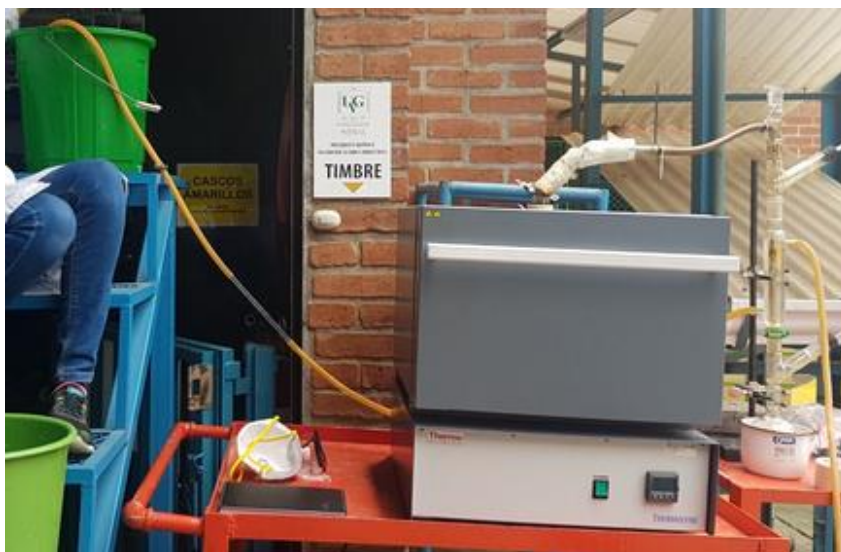
Figura 32. Sistema de pirólisis a escala laboratorio para la prueba 5 a 7.
