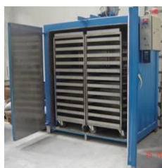
Figura 216. Horno – Deshidratador Industrial Corbett y sus especificaciones técnicas (Trifásico)
