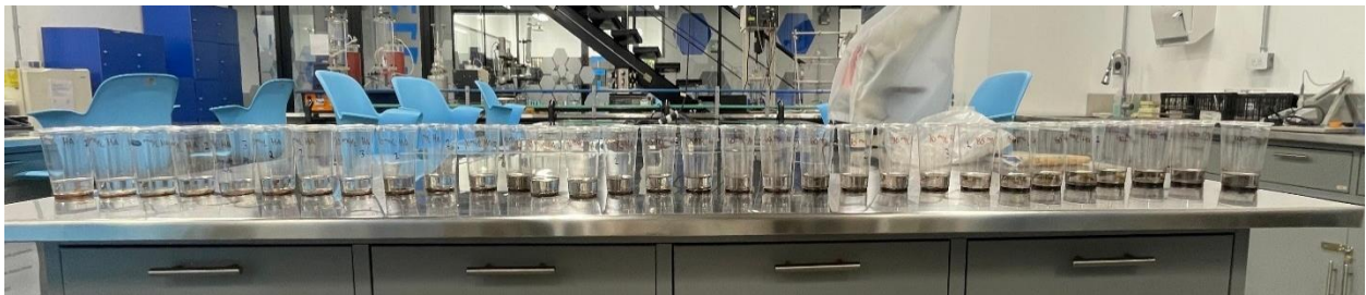
Figura 45: Imagen de las muestras de HAMLCD después de la adsorción para la isoterma de Langmuir
