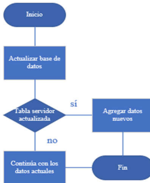
Ilustración 19 Diagrama de flujo actualizar base de datos
