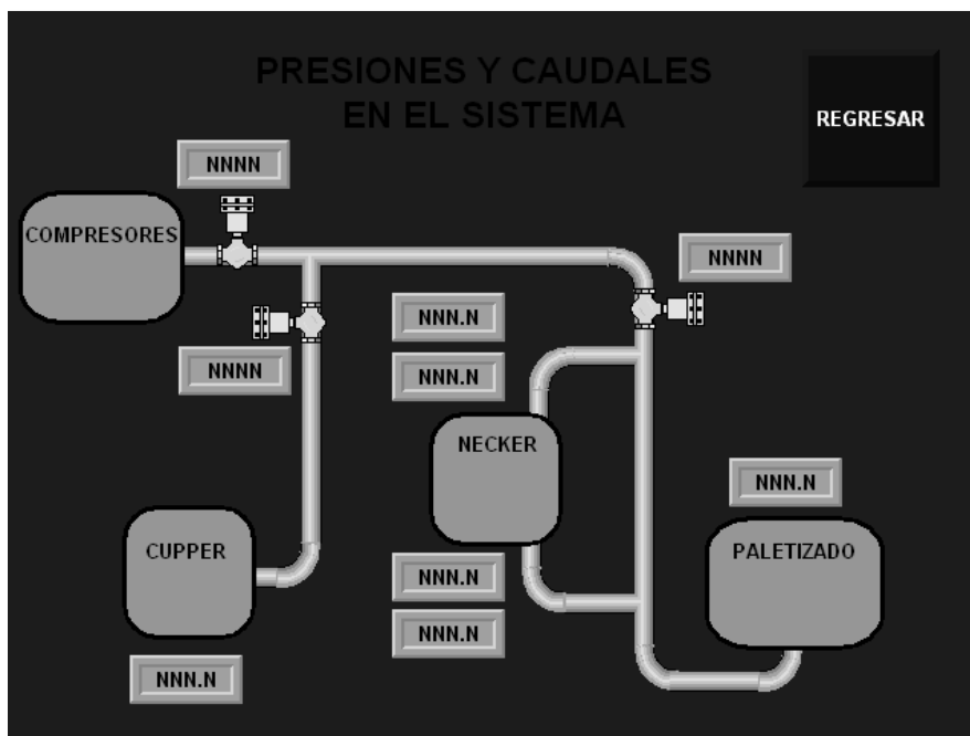
Figura 14: Pantalla para el monitoreo de caudales y presiones en la planta
